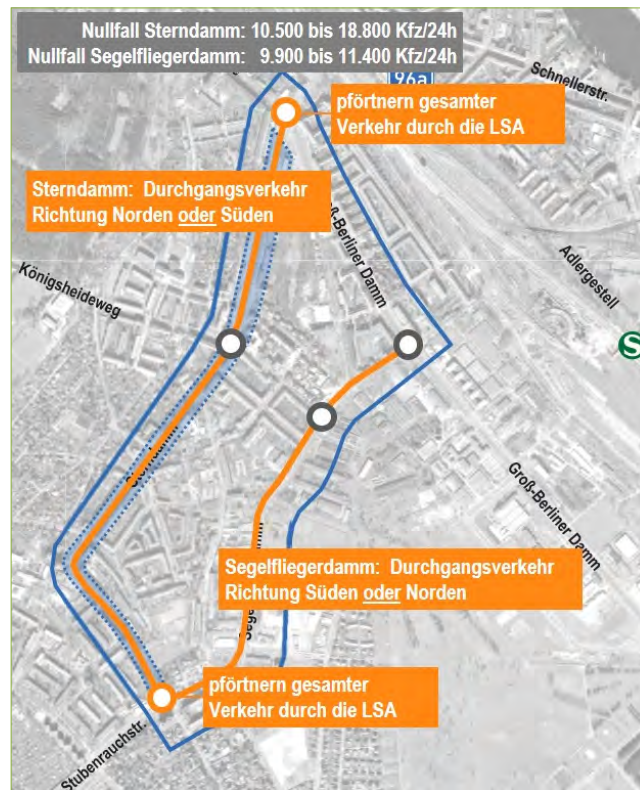
Abbildung 27: Pförtner des Verkehrs als Ringsystem über Stern- und Segelfliegerdamm (Maßnahmenansatz 5)
