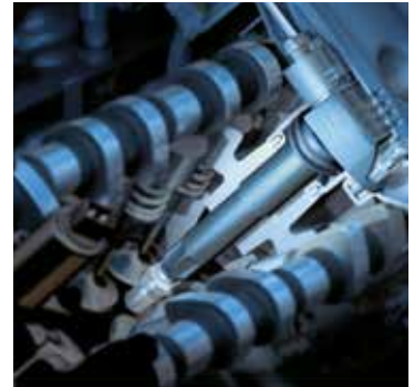
Kerzenschacht-Zündspulen befinden sich tief im Motorraum und müssen extremer thermischer Beanspruchung standhalten.
