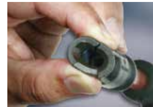
Durch Zusammendrücken des Zündkerzensteckers werden die Haarrisse deutlich erkennbar.
