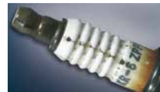
Brennspuren am Zündkerzenhals – ein Zeichen von Zündaussetzern.
