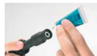
BERU Zündkerzen-Steckerfett. Vor dem Einschrauben der Zündkerze in den Stecker gestrichen, schützt es vor Versprödung und damit vor Hochspannungsüberschlägen.
