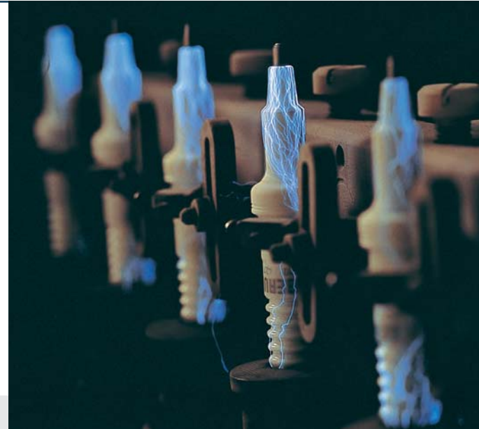
Isolatorenprüfung bei 40.000 Volt: Auf Prüfständen müssen BERU Zündkerzen ihre Zuverlässigkeit vor dem Serienanlauf unter Beweis stellen.
