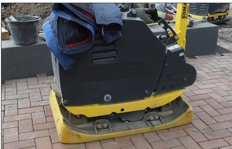
Bild 36: Vibrationsplatten mit planebener Unterseite eignen sich sehr gut zum Verdichten von Betonpflasterdecken (Foto: SLG)
