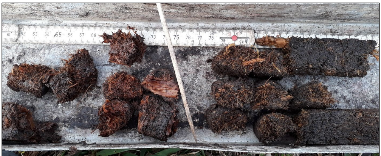
Abbildung 23: Ausschnitt aus seiner Handbohrung am Übergang von oxidativen zu reduktiven Bedingungen. Die Obergrenze des r-Horizontes liegt bei etwa 75 cm Tiefe unter Terrain und ist mit einem Holzstäbchen markiert. Darunter sind die Fasern gelblich gefärbt, darüber rötlich.
