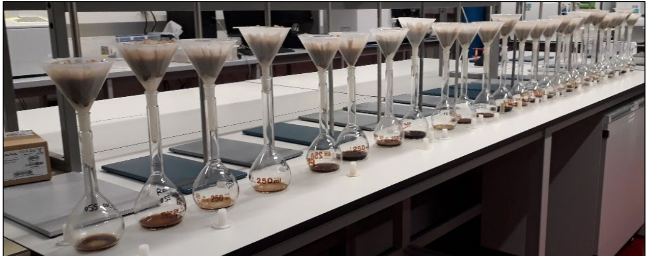
Abbildung 20: Messkolben mit Filtrat. In den Filterpapieren befinden sich die in Pyrophosphat gelösten Proben. Gut erkennbar ist die unterschiedliche Färbung des Filtrats von gelb über braun bis schwarz.
