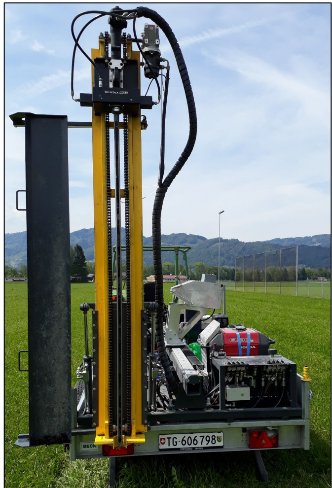
Abbildung 8: Bohrgerät mit aufgerichtetem Bohrgestänge und eingehängter 2 m Bohrstock. In der Mitte des Anhängers ist die parallel dazu verlaufende Schiene zu sehen, auf dieser fährt die metallene Kamerabox den abgelegten Bohrstock ab. Rechts die Steuerung der Hydraulik das Stromaggregat.
