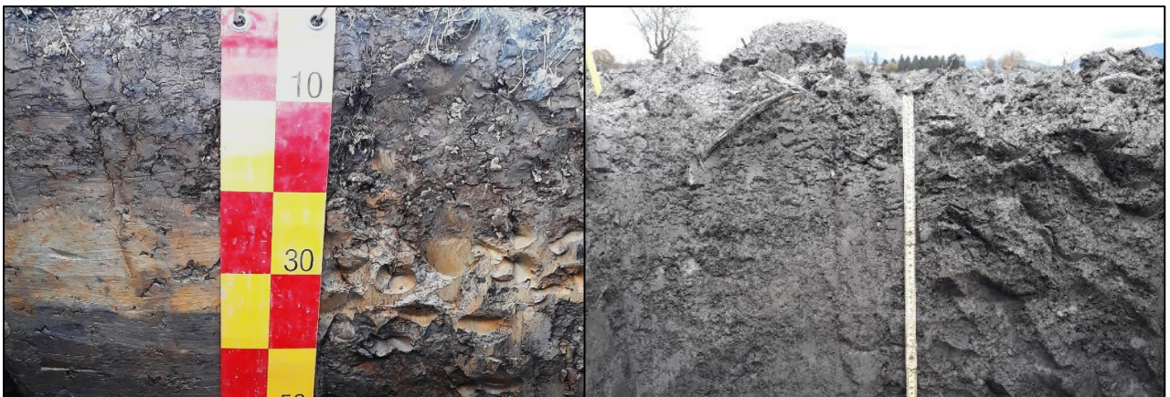
Abbildung 47: Beispiel zweier für den Perimeter typischer, problematischer Oberbodenkörnungen. Links ein Boden mit weit über 50 % Ton im Oberboden. Unterhalb der Pflugschicht hat sich ein Stauhorizont gebildet, der im oberen Bereich rostfleckig ist und in etwa 40 cm Tiefe grau wird. Die Vernässung durch Stauwasser ist stark ausgeprägt. Rechts ein Boden mit weit über 50 % Schluff, dessen Oberboden verschlämmt ist. Das Gefüge ist zu einer strukturarmen Masse zusammengedrückt worden und an der Oberfläche hat sich ein schwer durchlässiger Film gebildet. Die Infiltration von Wasser ist vermindert und die Durchwurzelbarkeit erschwert.
