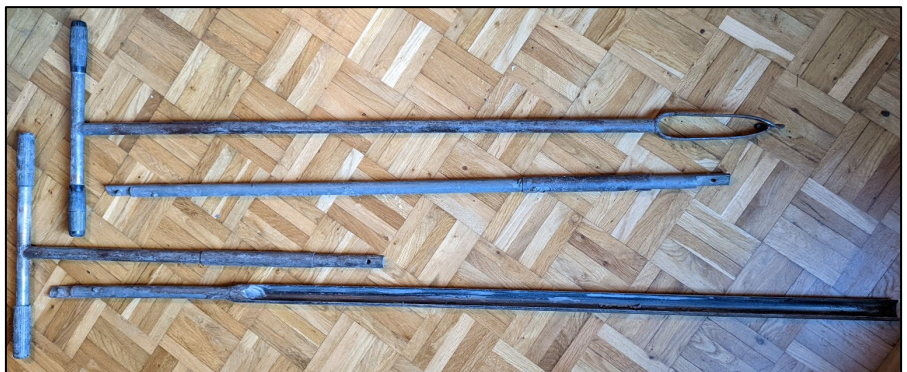
Abbildung 7: Handbohrer. Von oben nach unten. Holländerbohrer, Verlängerung, Stechbohrergriff, Stechbohrer.
