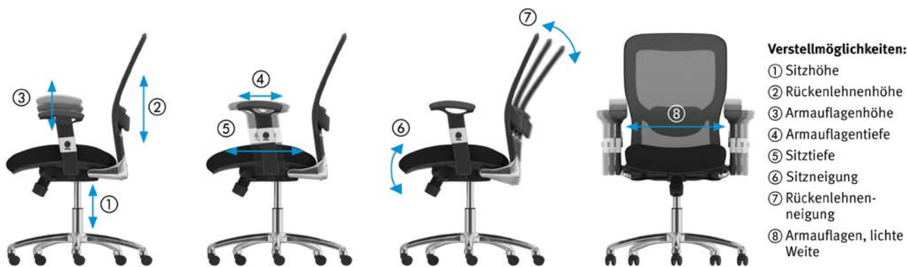
Abb. 34 Verstellmöglichkeiten an einem Büroarbeitsstuhl
