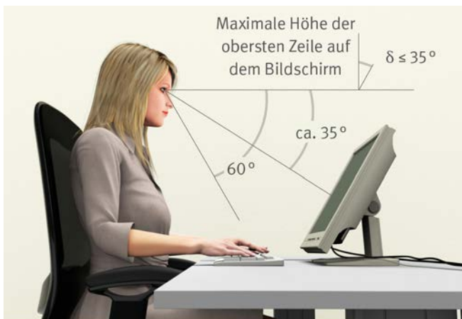
Abb. 20 Vertikales Blickfeld und Anordnung des Bildschirms
