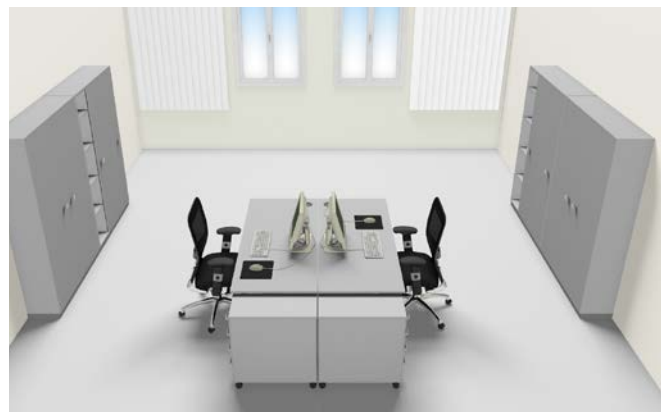
Abb. 44 Richtige Ausrichtung der Bildschirmarbeitsplätze zum Fenster
