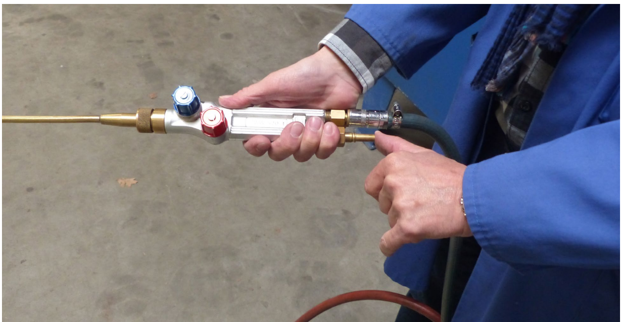
Abb. 7 Saugprobe an einem Injektorbrenner
