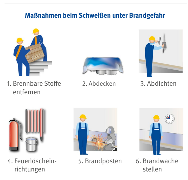
Abb. 15 Maßnahmen beim Schweißen unter Brandgefahr
