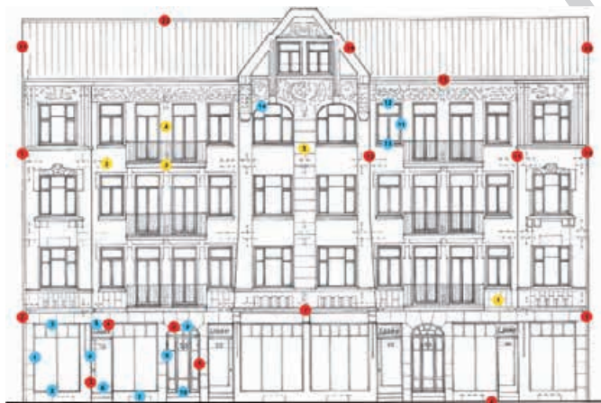
Bild 1. Wärmebrückenübersicht Straßenansicht Fig. 1. Overview of thermal bridges, street elevation
