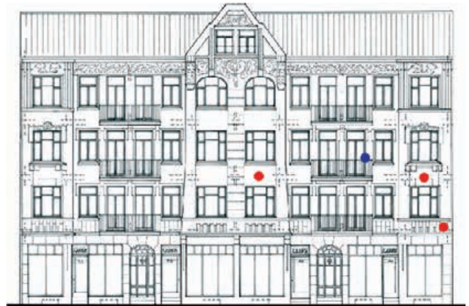
Bild 5. Markierung der Stoffprobenentnahme an der Straßenfassade
