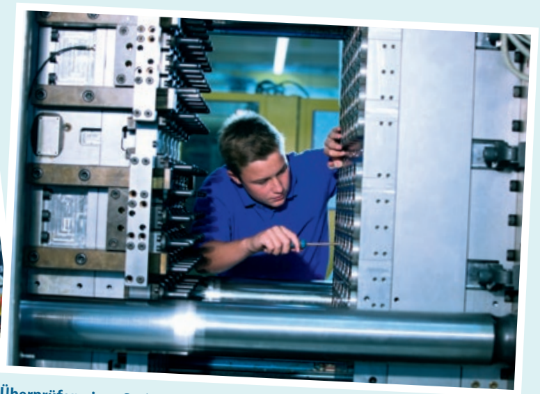
Überprüfen eines Spritzgießwerkzeuges
