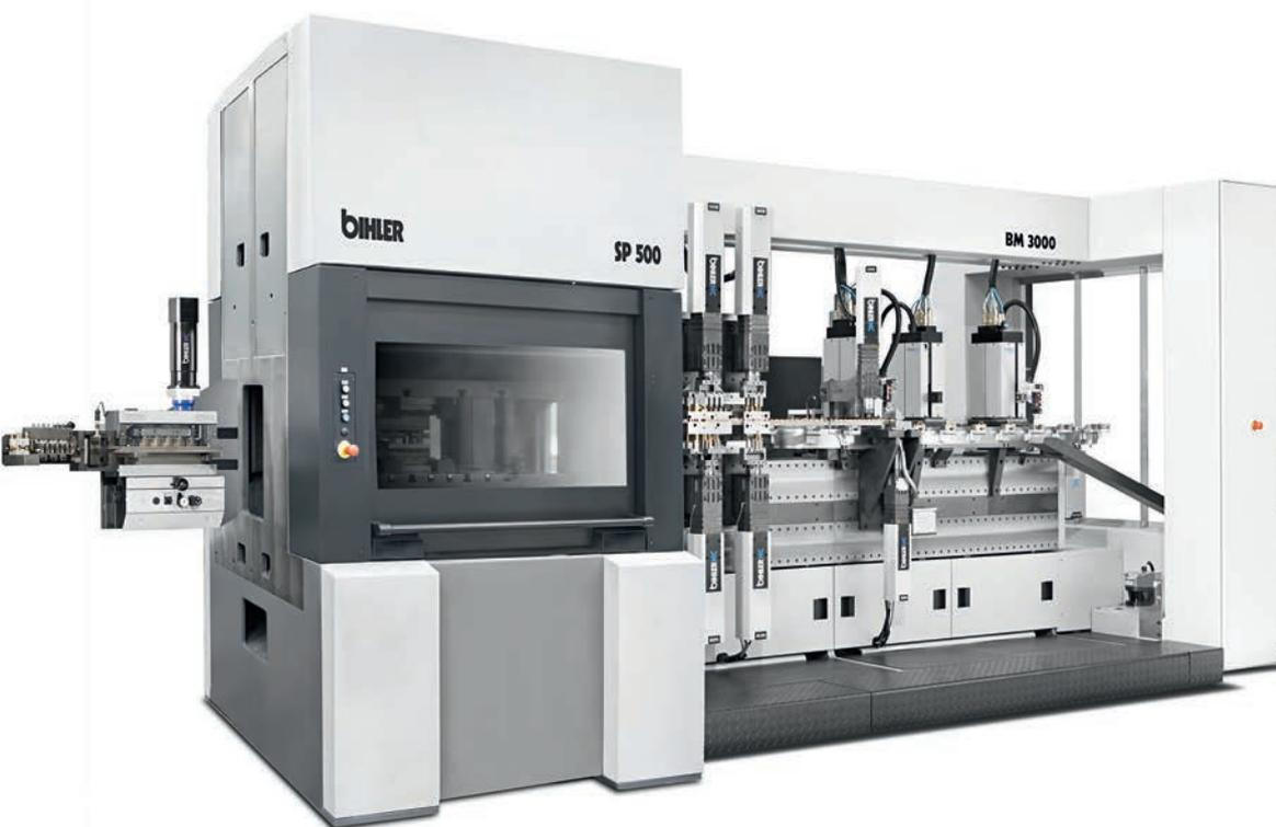
Das Fertigungs- und Montagesystem BIMERIC SP ist eine revolutionäre Kombination aus BIMERIC und der Servopresse SP 500 zur Baugruppenfertigung im Folgeverbund.
