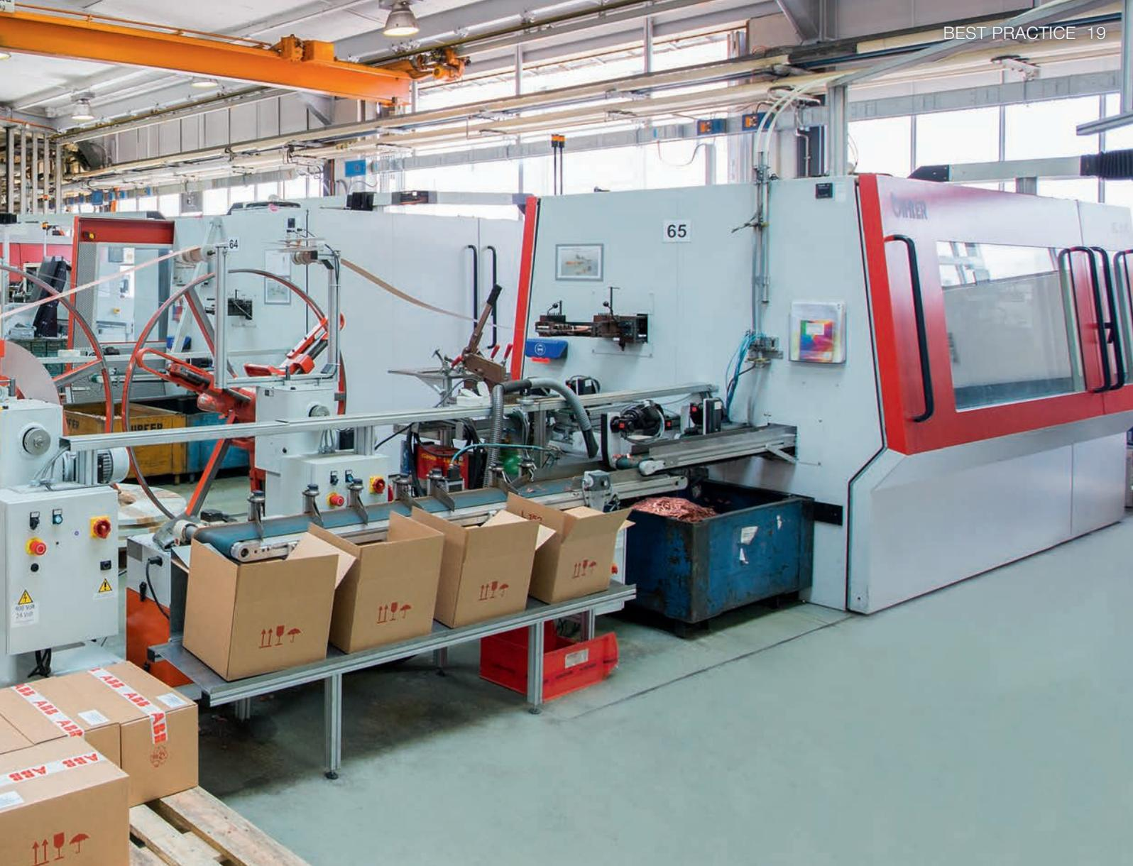
Die beweglichen Kontaktteile für die Leitungsschutzschalter werden auf zwei GRM 80P Stanz-Biegeautomaten hergestellt. Die Taktrate ist mit je 200 Teilen pro Minute rund dreimal so hoch wie bei alternativen Verfahren.
