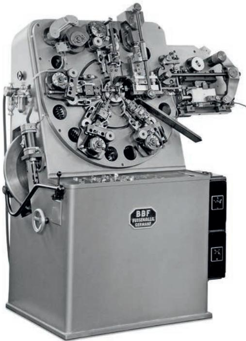
**Grundstein für jahrzehntelangen Erfolg: der weltweit erste radiale Draht- und Bandbiegeautomat, 1955/56 von Otto Bihler entwickelt.**
