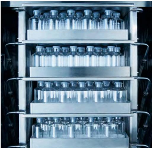
Avec des dessiccateurs de production plus grands, il est de plus en plus fréquent d'utiliser des systèmes de chargement/déchargement automatisés. L'espacement entre les étagères doit également s'adapter aux mécanismes de ce type d'équipements.
