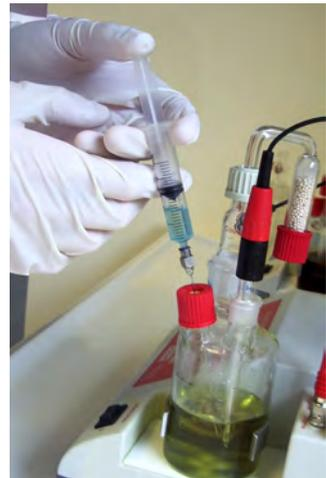
*Figure 15 : Titration Karl Fischer, une technique courante, mais destructive pour analyser l'humidité*
