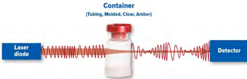
Figure 16 : La spectroscopie à modulation de fréquence est une technique permettant une analyse non destructive à grande échelle. Ci-dessous : cartographie des degrés d'humidité finale sur une étagère utilisant la spectroscopie à modulation de fréquence
