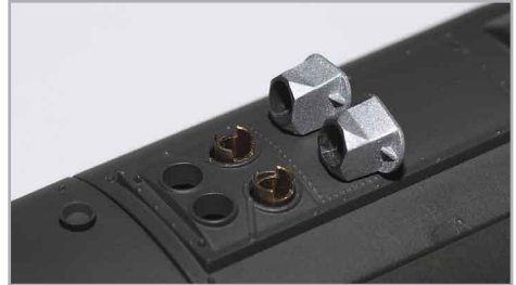
Abb. 9: Abnahme der Dachhutzen
