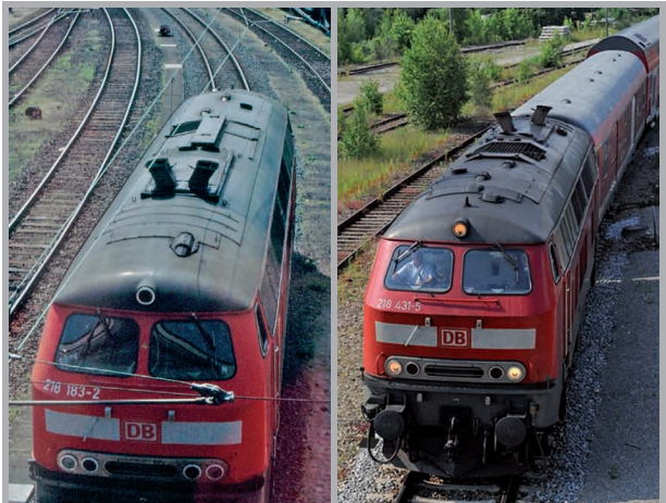
218 183 trägt einen abgasoptimierten MTU 12 V 956 TB 11 und parallele Hutzen. Die einstmals mit dem Pielstick-Motor bestückte 218 431 wird von einem MTU 16 V 4000 R 40 befeuert. Die versetzte Anordnung der Hutzen wurde beibehalten.
