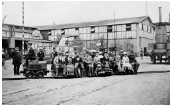
Die Erfinder: Auf der Berliner Gewerbeausstellung 1879 wird die erste elektrische Lokomotive von Werner Siemens und Johann Georg Halske vorgestellt.
