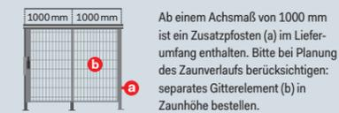
Ab einem Achsmaß von 1000 mm ist ein Zusatzpfosten (a) im Lieferumfang enthalten. Bitte bei Planung des Zaunverlaufs berücksichtigen: separates Gitterelement (b) in Zaunhöhe bestellen.
