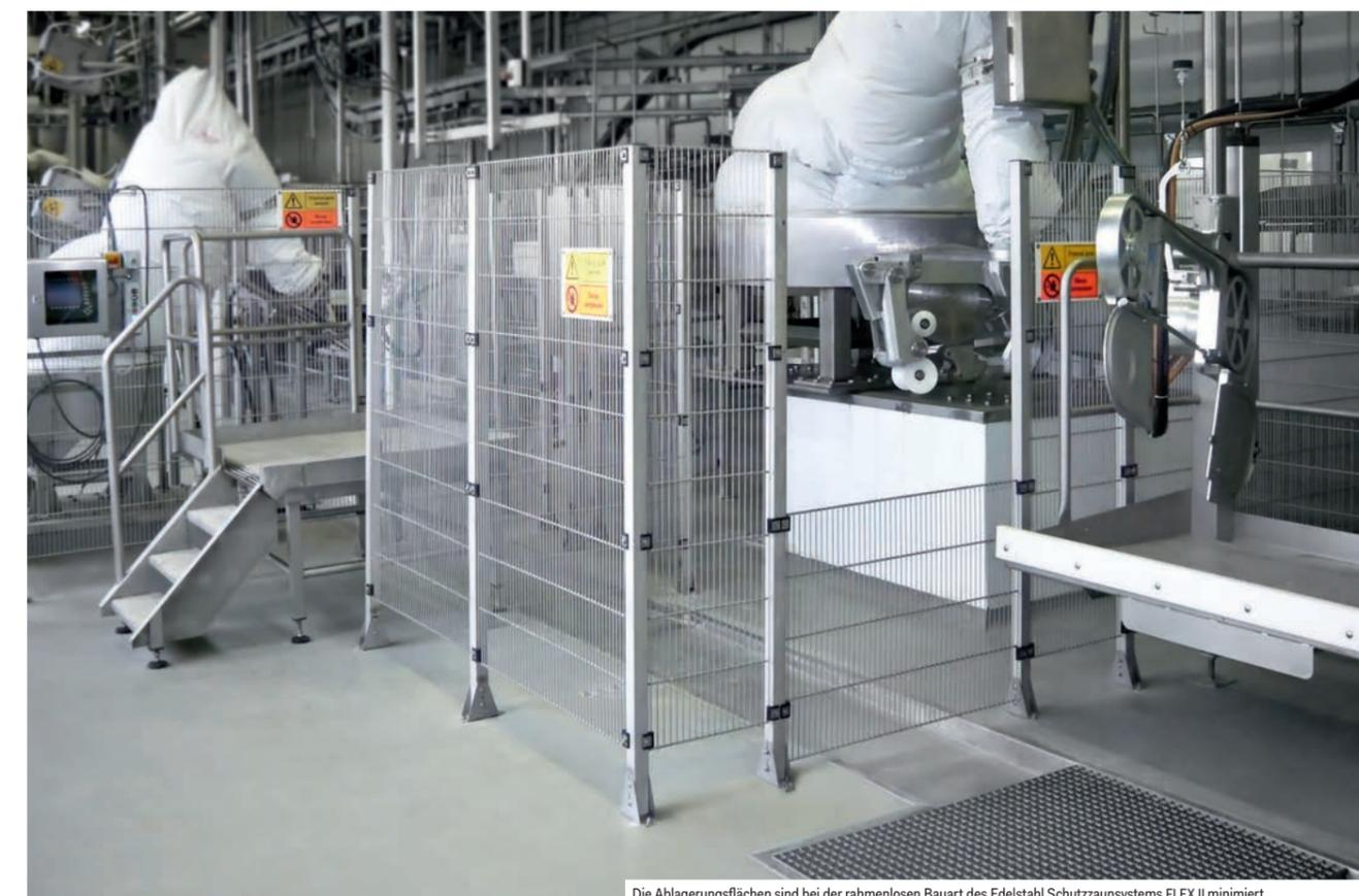
Die Ablagerungsflächen sind bei der rahmenlosen Bauart des Edelstahl Schutzzaunsystems FLEX II minimiert
