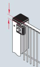
Unverlierbarkeit des Befestigungsmittels am Gitterelement
