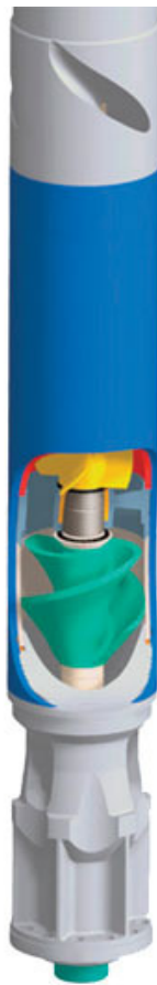
Abb. 6.62: Schematische Darstellung eines Gasseparators (Lea et al. 2005)
