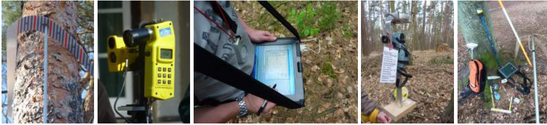
Abbildung 3.2: Aufnahmegereäte der BWI 2012, u. a. Hochkluppe, Criterion, Feldcomputer, Kompass, Spiegelrelaskop, Vertex, GNSS-Gerät, Maßband, Kluppe
