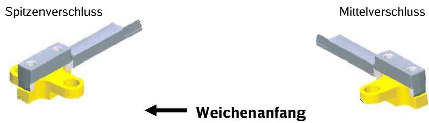
Bild 19 Montage der Seitenanriffe bei Weichen mit Verschlusschwellen
