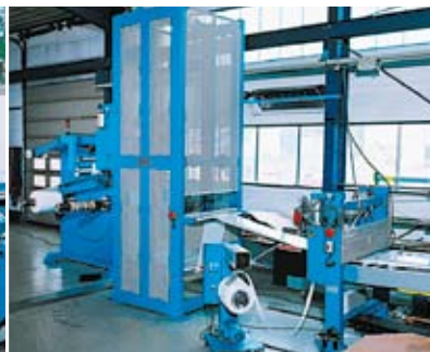
Wickler Warenspeicher und Abzugseinrichtung
