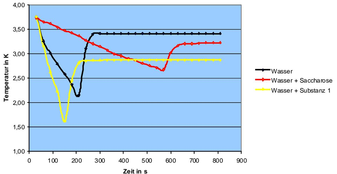
Der relative Gefrierpunkt des Wassers lag bei dem im Versuch verwendeten Beckmann-Thermometer bei 3.41. Die Gefrierpunktsdepressionen betragen also
