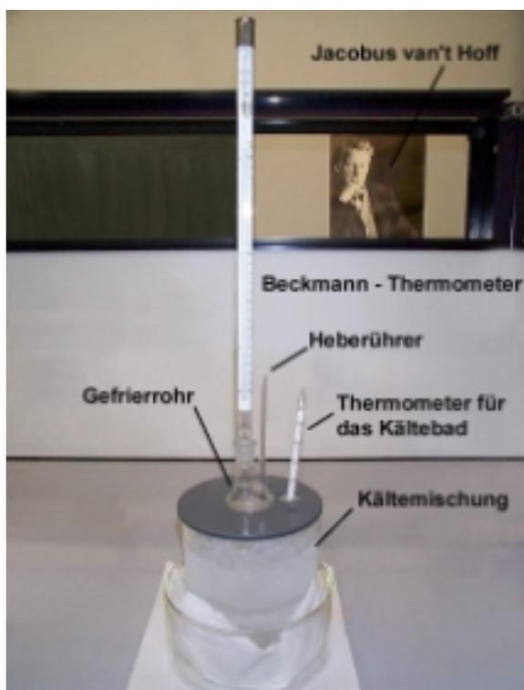
Als Kältemischung wird Eis und Kochsalz im Verhältnis 3:1 angesetzt, womit etwa  $-20^{\circ}\text{C}$  erreicht werden können. In diese Mischung wird das Gefrierrohr eingetaucht, das die zu untersuchende Lösung, ein Beckmann-Thermometer und einen Heberührer enthält. Mit einem zweiten Thermometer kann die Temperatur des Kühlgefäßes kontrolliert werden.
