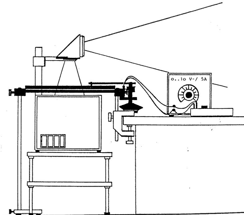
Der Abbildung entsprechend befestigt man die eine Seite des Schwingrahmens mit den beiden Tischklemmen und kurzen Stativstangen am Experimentiertisch. Der Abstand zwischen Schwingrahmen und Tischplatte sollte möglichst klein sein.
