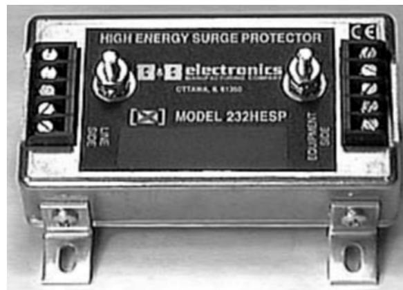
**Abbildung 8.53** RS-232-Überspannungsableiter mit besonders hoher Schutzwirkung (High Energy Surge Protector). Kann Störspannungen bis zu 6 kV ableiten (B&B Electronics)
