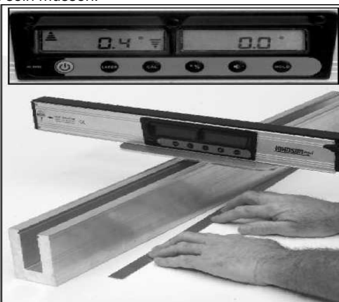
Mit dem "PAL" Werkzeug sicherstellen, dass die Sockelschiene an allen Punkten horizontal liegt. Beim Nivellieren der Sockelschiene sicherstellen, die Sockelschiene innerhalb von 0,4 Grad des Bodens zu nivellieren. Eine Winkelabweichung bis zu 0,4 Grad ist bei diesem Prozess annehmbar.
