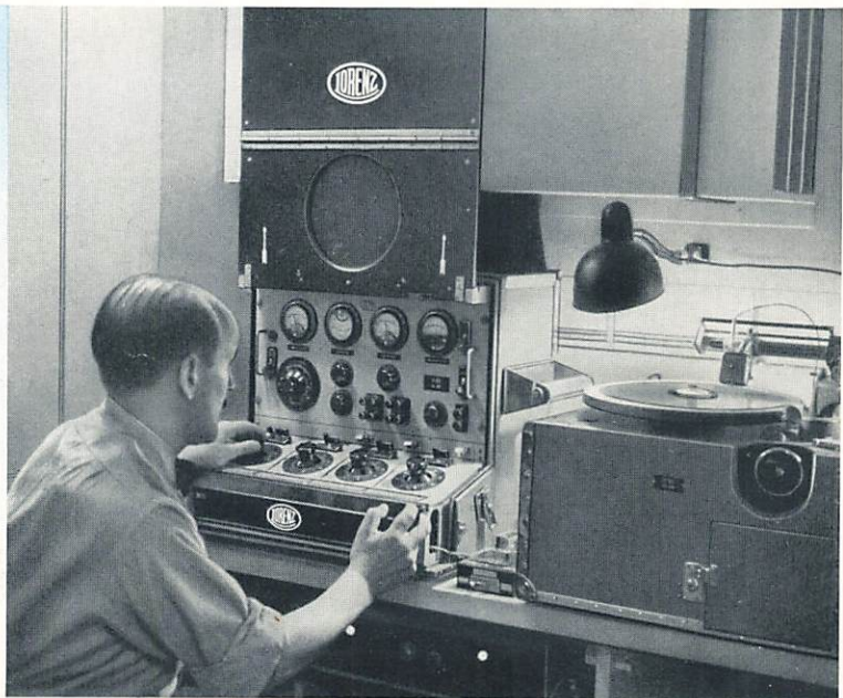
Abb. 22. Schneiden von Schallplatten mit der Übertragungs-Apparatur V 35, Reichssportfeld Berlin.
