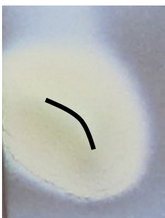
Abbildung 7.61: Spritzflecke und Querschliffe für unterschiedliche Arbeitsgasdurchsätze, konstant elektr. Leistung 37 kW, VMT_1.0 Düse
