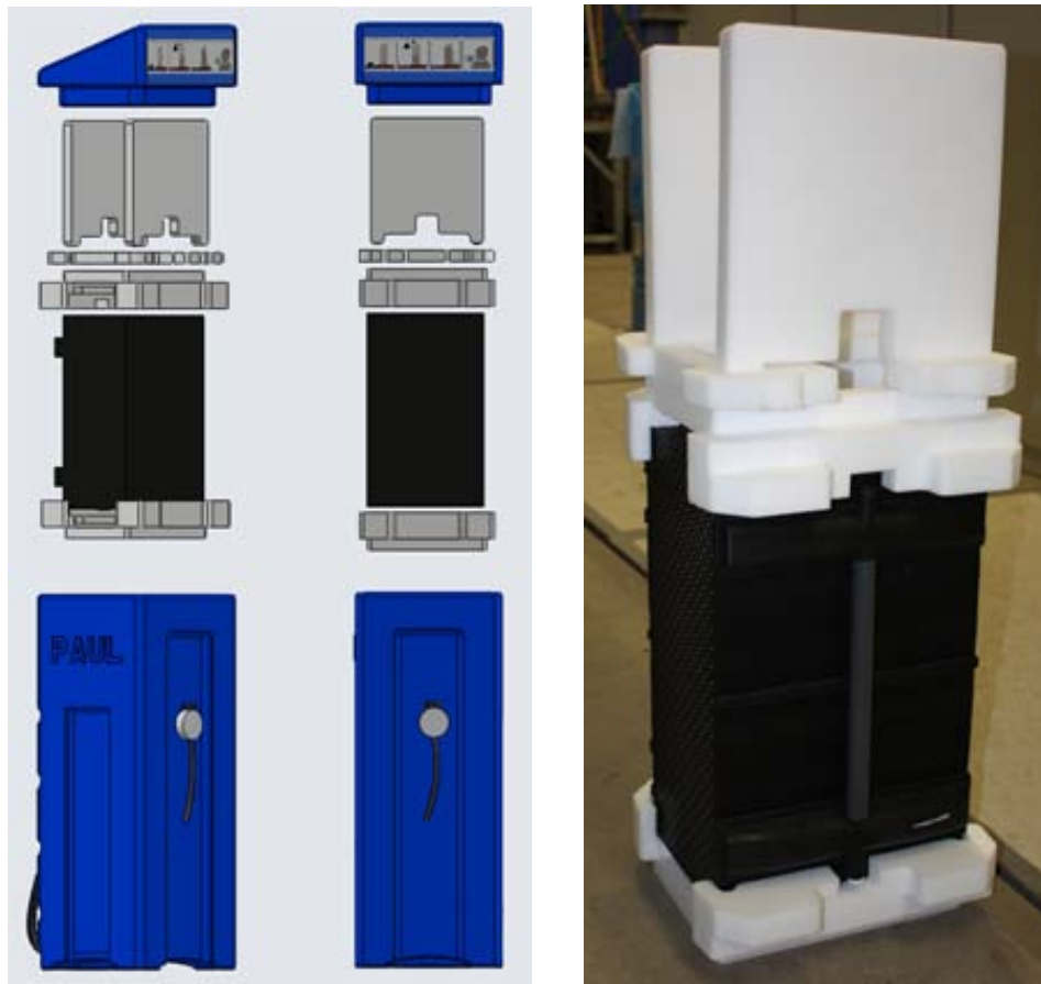
Abbildung 30: 3D-Abbildung (links) und Foto (rechts) der Endversion des Wasserrucksack inklusive Dämmung
