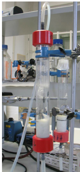
Abbildung 6) Mit Glaswolle gepackte Säulen (Quelle: UBA, FROHNERT)
