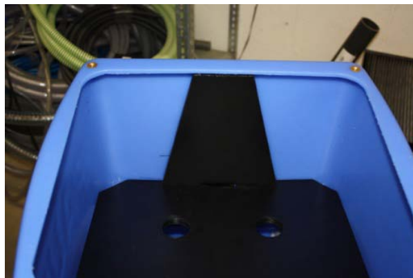
Abbildung 24: PE-Platte zur Abstützung nach oben, Version 2
