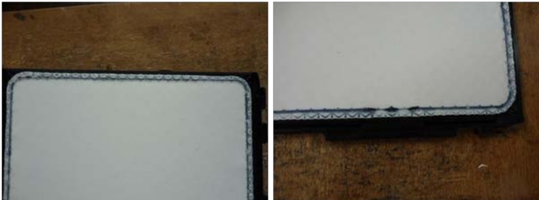
Abbildung 42: Ungleichmäßige Schweißkante (links), Fehlstelle Schweißkante (rechts)
