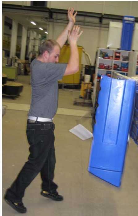
Abbildung 27: Falltest mit der Dämmung Version 3, Fall aus ca. 2 m auf die Kopfseite, Untergrund Beton
