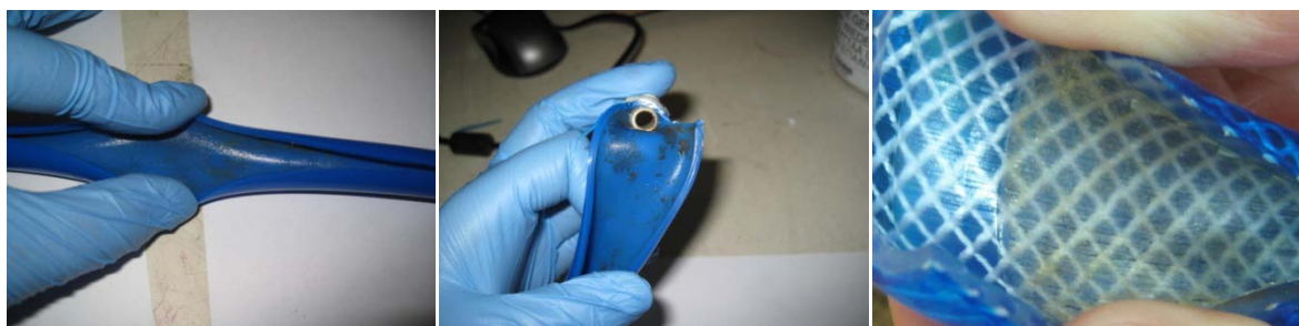
Abbildung 88: Ablagerungen im Ablaufschlauch (10 mm)
