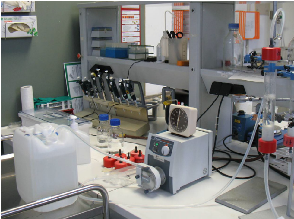
Abbildung 7) Filtration einer Wasserprobe über Glaswolle (Quelle: UBA, FROHNERT)
