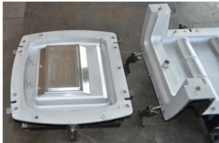
Abbildung 7: Geändertes Werkzeug (Gehäuseoberteil) mit abgesenktem Rand (links)
