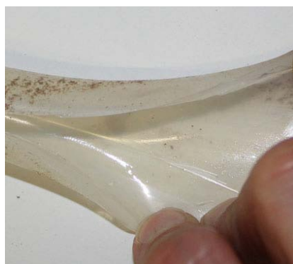
Abbildung 90: Innenseite des Silikonschlauches zur Verbindung von Kugelhahn und Membranmodul
