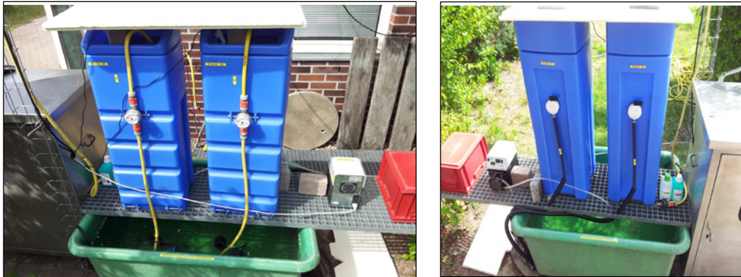
Abbildung 11) Freilandexperiment auf dem Versuchsaufbau Marienfelde (PAUL A u. B). Betrieb mit ca. 99 % Oberflächenwasser und ca. 1 % Abwasser. Links: Rückseite mit Zulauf, Wasserzähler, Mischvorlagewanne, Dosierpumpen. Rechts: Vorderseite mit Ablauf, Mischvorlagewanne (Quelle: UBA, MUDRA).
