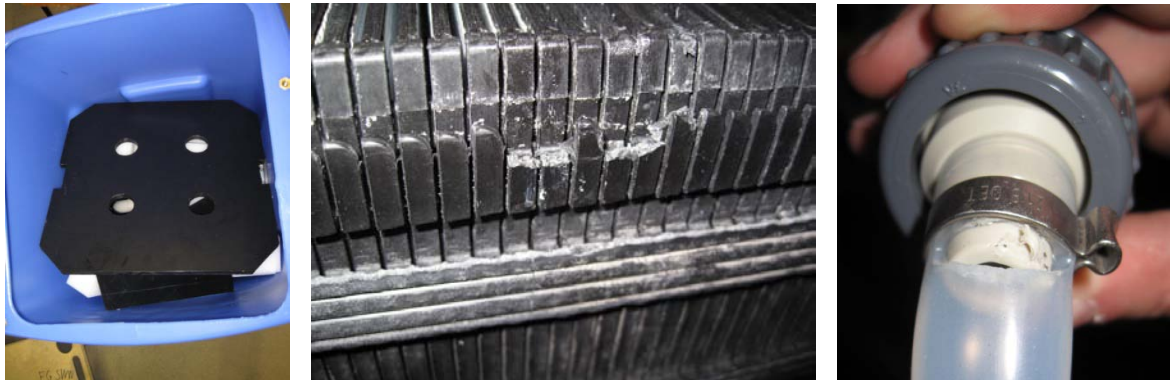
Abbildung 25: Schadenbilder nach einem Sturz aus 2 m Höhe auf die Kopfseite des Wasserrucksacks, Version 2
