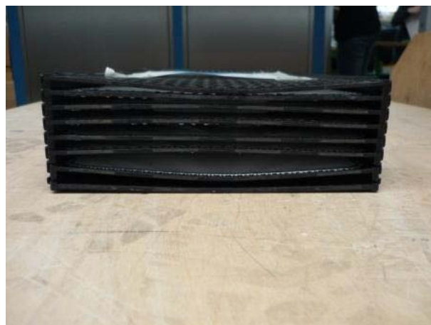
Abbildung 33: Schweißversuch PP Gf 20
