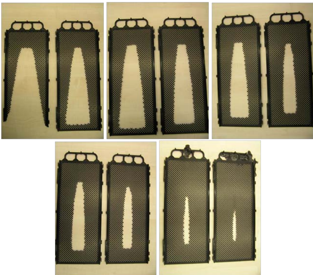
Abbildung 38: Fließverlauf des Kunststoffes
