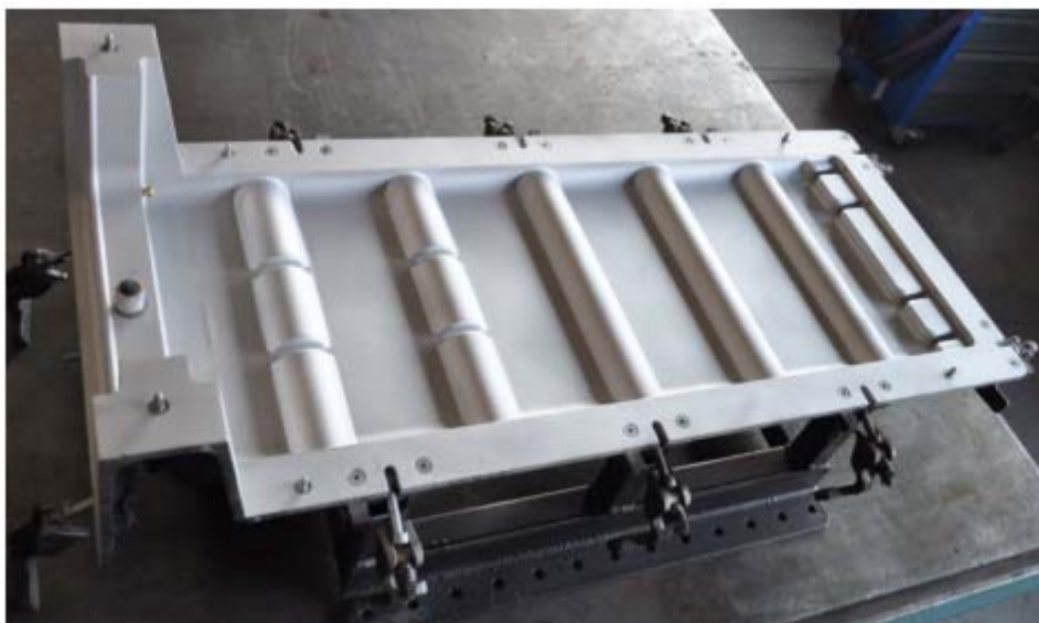
Abbildung 10: Gehäusewerkzeug mit zusätzlicher Quersicke
