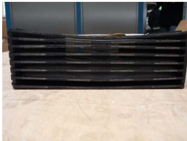
Abbildung 32: Schweißversuch Mischung PP Gf 20 / Tecnoprene
