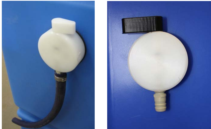
Abbildung 16: Kugelhahn aus Vorgängerprojekt (links), aktueller Kugelhahn mit verändertem Griff und veränderter Schaltstellung (rechts)
