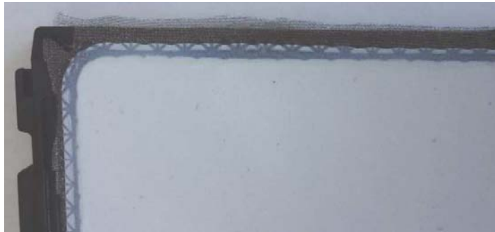
Abbildung 44: Stoffbahn aus Silber, die zwischen Membran und Membranplatte eingearbeitet ist.
