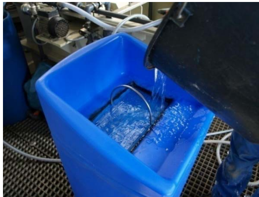
Abbildung 5: Befüllung des Wasserrucksacks durch das integrierte Langlochsieb
