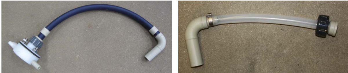
Abbildung 15: Anschlussset mit steifem Trinkwasserschlauch aus dem Vorgängerprojekt (links), aktuelles Anschlussset mit flexiblem Silikonschlauch (rechts)
