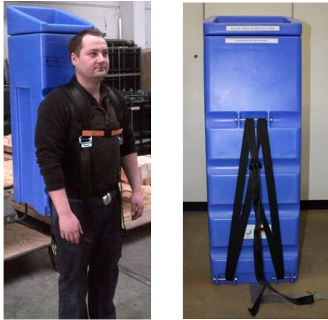
Abbildung 9: Einfaches Gurtsystem aus PES-Gurtband (rechts), gepolstertes Gurtsystem für weitere Strecken (links)
