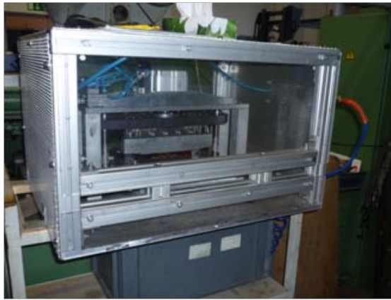
Abbildung 41: Stanzvorrichtung zur Abtrennung des Angusses
