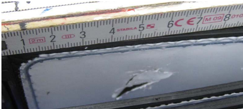
Abbildung 86: Membran mit deutlich sichtbarem Schnitt
