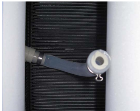
Abbildung 28: Schadensfall nach Falltest aus Abbildung 27 (Version 3)
