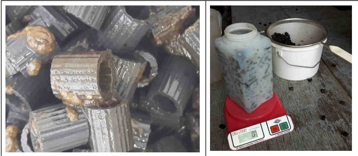
Bild 4-6: Bewachsenes Trägermaterial (links); Messung Gewicht Trägermaterial (rechts) (Lerner 2016)
