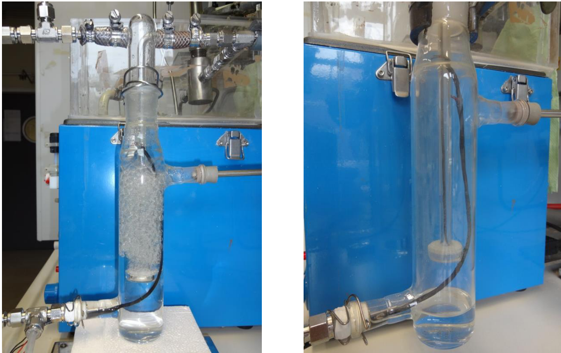
Abbildung 40: Aufnahmen des Behälters für die Direktkondensation (Kondensator).
