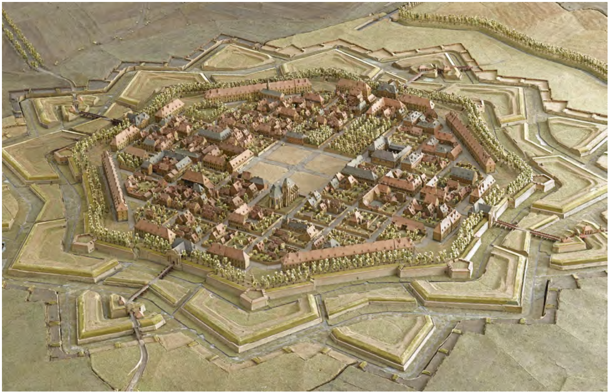
Abbildung 19: Modell der Stadt Neuf-Brisach im Masstab 1:600, 1703–1706 vom Ingenieur MONTAIGU angefertigt.
