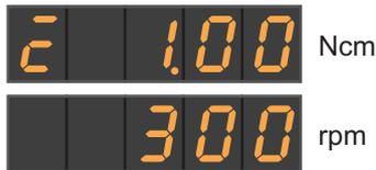
Um zwischen Drehmoment- und Drehzahlwerten unterscheiden zu können, wird die Anzeige Bohrantrieb kalibriert/ nicht kalibriert und AutoReverse-Funktion ein/aus nur beim Drehmomentwert angezeigt.
