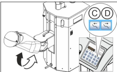
Über die Tasten (C) und (D) auf der Bedienoberfläche am Arztelement oder über den Kreuzfußschalter lässt sich der Patientensimulator hoch und runter fahren.
