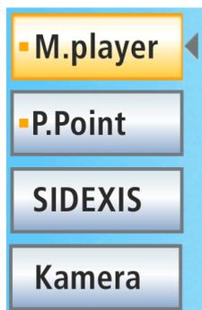
PC-Anwendungen werden von der Simulationseinheit automatisch gestartet. Auf dem Touchscreen wird durch ein orangefarbenes Quadrat vor dem Feld der jeweiligen PC-Anwendung gekennzeichnet, ob die Anwendung auf dem PC gestartet und betriebsbereit ist. Solange das orangefarbene Quadrat nicht eingeblendet ist, kann mit der PC-Anwendung noch nicht kommuniziert werden.
