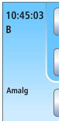
Wenn auf der EasyPad-Anzeige oder in der Statusspalte des Touchscreens die Anzeige *Amalg* erscheint, ist der Amalgamrotor fast gefüllt und muss daher baldmöglichst ausgetauscht werden. Ist der Rotor vollständig gefüllt, ertönt zusätzlich ein akustisches Signal. Durch eine Sicherheitsabschaltung wird dann sichergestellt, dass die Simulationseinheit erst nach dem Rotortausch wieder in Betrieb genommen werden kann.
