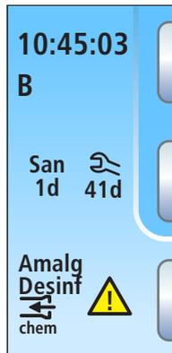
Unterhalb der Uhrzeit und des aktiven Benutzerprofils erscheinen die Tage bis zur nächsten Sanierung und zum nächsten Wartungstermin oder Statusmeldungen, wie Amalgamabscheider wechseln, Desinfektionsmittel nachfüllen, Reinigungsmittel für chemische Saugschlauchreinigung nachfüllen oder Fehlermeldungen.
