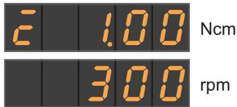
Bei eingeschalteter Endo-Funktion kann zur Einstellung der Drehzahl die EasyPad-Anzeige zwischen Drehmoment- und Drehzahlwerten umgeschaltet werden.
