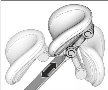
Die Doppelgelenk-Kopfstütze ist mit zwei Drehgelenken ausgestattet. Diese erlauben die manuelle Einstellung der Kopfneigung für Ober-/ Unterkieferbehandlungen. Zur manuellen Anpassung an die Patientengröße kann der Kopfstützenausschub eingeschoben oder herausgezogen werden.
