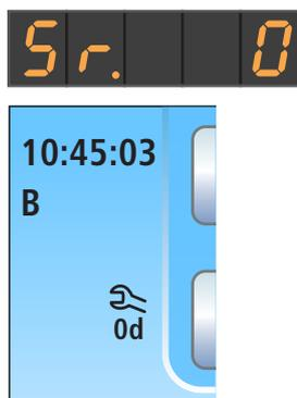
Auf der EasyPad-Anzeige erscheint der Text „Sr.“ und die Anzahl der Tage bis zum Wartungstermin. Auf dem EasyTouch erscheint in der Statusspalte des Touchscreens ein Schraubenschlüssel-Symbol. Die Tage bis zum Wartungstermin werden heruntergezählt (z. B. 13 d = 13 Tage). Setzen Sie sich schon jetzt mit Ihrem Händler oder Sirona in Verbindung und vereinbaren Sie einen Termin.
