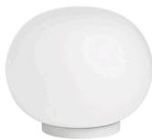
Tischleuchte für diffuses Licht. Diffusor bestehend aus einem mundgeblasenem, verschaltem Opalglas mit geätzter Außenfläche und einem Haltering mit Gewinde aus weißem, spritzgegossenem PBT Abdeckung, Fuß/Lampenfassung aus weißem, spritzgegossenem PBT.
