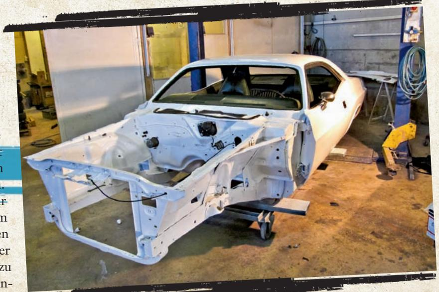
Gleicher Grundgedanke, wesentlich solider ausgeführt: Der Challenger-Rahmen ist nur auf den ersten Blick mit dem des Mustangs vergleichbar
