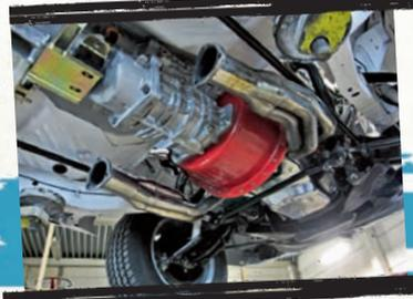
Auch neben einem modernen Fünfgang-Getriebe bleiben die in Längsrichtung verbauten Drehstäbe der Challenger-Vorderachse sichtbar
