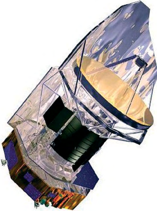
Abb. 3.3: Computerbild des zukünftigen europäischen Weltraumteleskops Herschel (ESA) im Weltraum nahe dem L2-Librationspunkt. Im oberen Teil ist das 3,5-m-Teleskop zu sehen, darunter der Kryostat mit den drei Instrumenten und dem superfluiden Heliumkühlmittel. Der untere Teil ist der Satellitenbus. Der Satellit wird durch einen großen Schild (der gleichzeitig auch die Sonnenpaneele enthält) vor der Wärmestrahlung von Erde und Sonne geschützt und kann sich so auf unter 100 K passiv abkühlen. (ESA)
