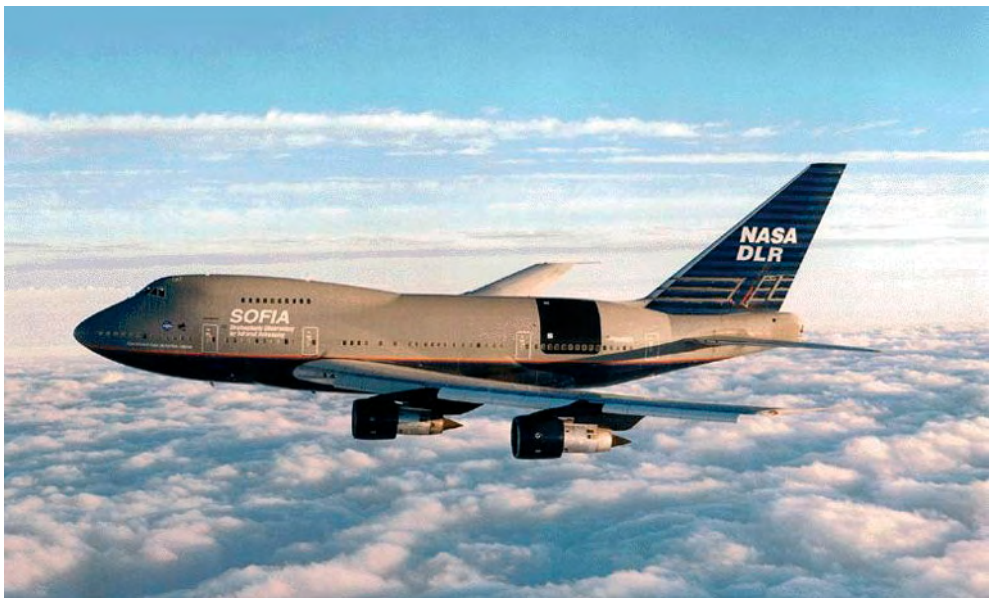
Abb. 3.6: Das Flugzeugteleskop SOFIA während eines Testflugs. In dem schwarz markierten Teil des Flugzeugs wird das Teleskop arbeiten. (NASA/DLR)
