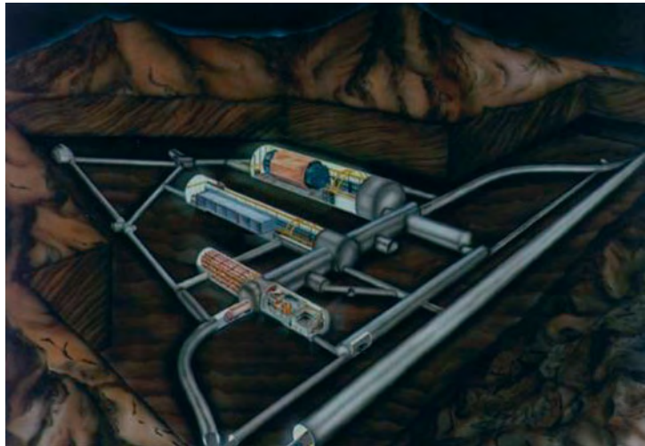
Abb. 3.9: Schematischer Querschnitt durch das Gran-Sasso-Labor. Deutlich zu sehen sind die drei Laborhallen, die unter anderem die Experimente GALLEX/GNO, CRESST und BOREXINO beherbergen, sowie der durchgehende Autotunnel. (LNGS)
