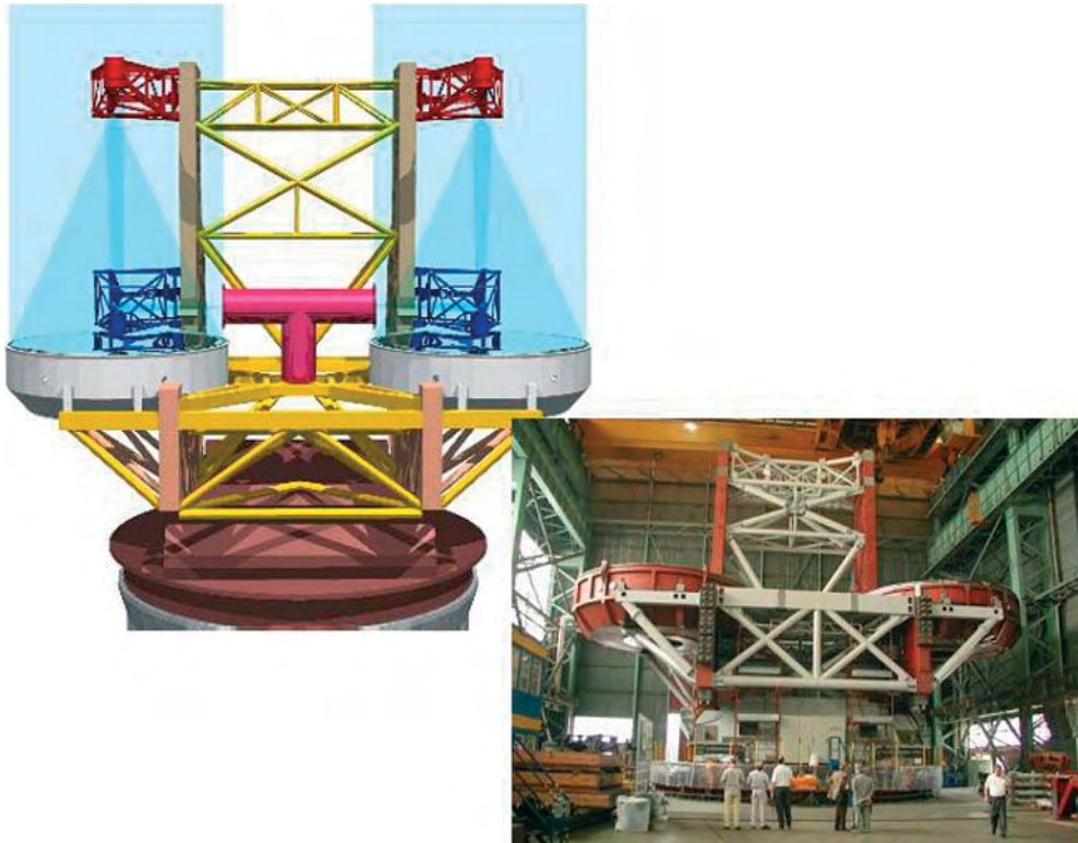
Abb. 3.5: Das Large Binocular Telescope (LBT). Links oben: Konzeption des LBT. Erkennbar sind die beiden Hauptspiegel mit jeweils 8.4 m Durchmesser sowie das rot gekennzeichnete Strahlkombinationsgerät, in dem für hochauflösende Messungen das Licht aus beiden Einzelteleskopen zur Interferenz gebracht wird, und somit ein Teleskop mit einem effektiven Durchmesser von 22 m geschaffen wird. Rechts unten: Bild der in der Firma Ansaldo hergestellten Teleskopstruktur, aufgenommen im Sommer 2001. (LBTB/LBTC)
