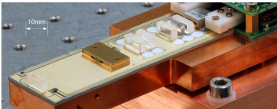
Abb. 1 Montageoptimierter Slab-Festkörperlaser
