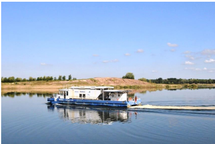
Abb. 4-7: Pilotvorhaben zur Herstellung eines Hydrogenkarbonatpuffers im Lichtenauer See: Kalkeintrag durch das Sanierungsschiff „Barbara“ (Foto: LMBV, Juni 2013)
