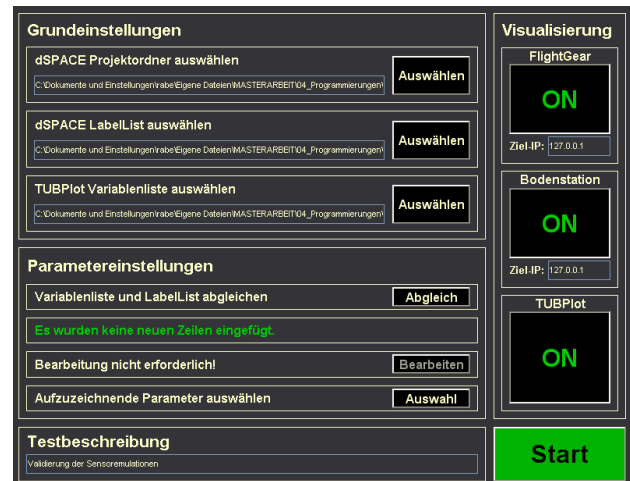
BILD 10. Grafische Benutzeroberfläche für HIL-Tests
