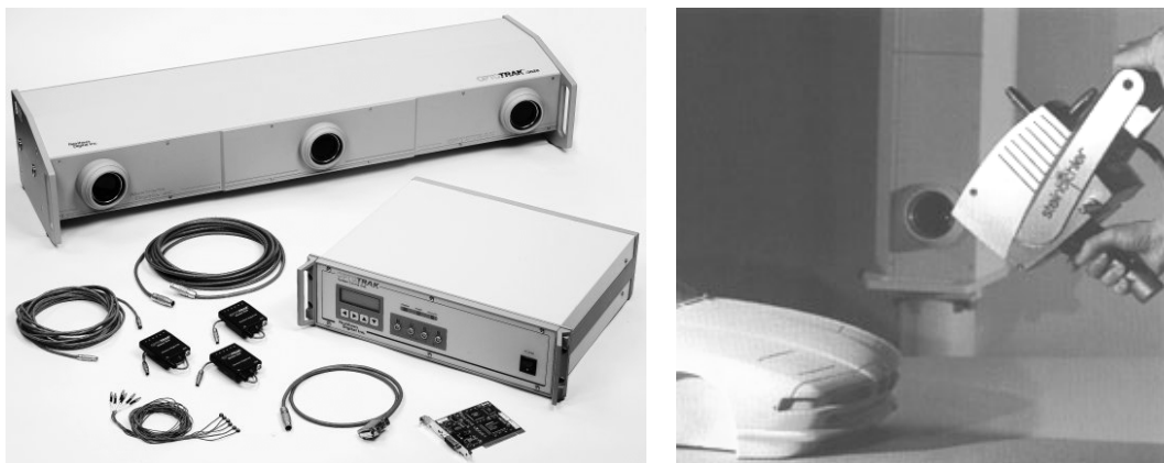
Abb. 3: Optisches Trackingsystem Optotrak 3020 (links, © Northern Digital Inc.) und Gesamtsystem Steinbichler Comet T-Scan (rechts, © Steinbichler Optotechnik)
