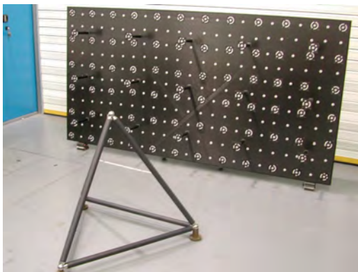
Abb. 4: Überprüfung der Absolutgenauigkeit mit Tetronom
