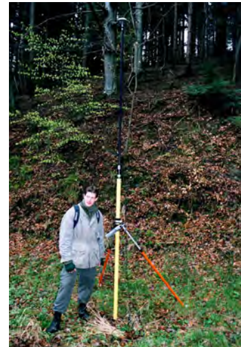
Abb. 2: GPS-Messungen in den Testgebieten mit dem zwei Frequenz LRK-GPS-System Scorpio 6502 SK/MK von Thales Navigation.
