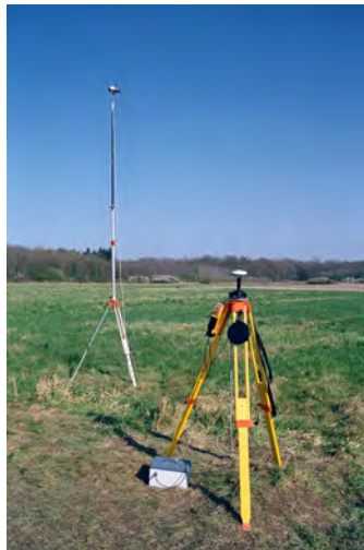
Abb. 2: GPS-Messungen in den Testgebieten mit dem zwei Frequenz LRK-GPS-System Scorpio 6502 SK/MK von Thales Navigation.
