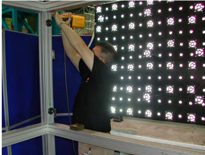
Abb. 6: Antastung einer Messkugel an der Rahmenkonstruktion
