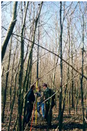
Abb. 2: GPS-Messungen in den Testgebieten mit dem zwei Frequenz LRK-GPS-System Scorpio 6502 SK/MK von Thales Navigation.
