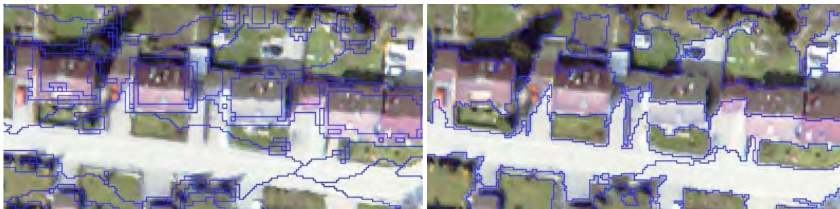
Abb. 2: Segmentierung basierend auf Höhen-Krümmungen trennt Gebäudebestandteile vom Rest sehr gut, Straßenkörper von Umgebung jedoch schlecht (links) - Segmentierung basierend auf NDVI zeigt den umgekehrten Effekt (rechts).
