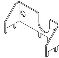
Duplex: Montage auf Printplatte (PCB)
