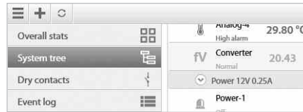
Abb.: Nachdem Sie den Sensor Messumformer (Art.Nr. 14100) mit dem Didactum Monitoring System verbunden haben, wird dieser im Webinterface automatisch angezeigt.
