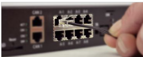
Abb.: Plug & Play Montage der intelligenten Didactum Sensoren. Per Autoidentifikation wird der Sensor sofort erkannt. Jeder Sensor besitzt ein SNMP OID.
