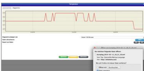
Abb.: Export als CSV- oder XML-Datei direkt aus dem Ethernet basierten Didactum Mess- und Alarmsystem. Ideal für Audits, Checklisten und Reports.
