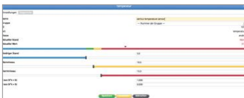
Abb.: Jeder Sensor kann im WebGUI des Didactum Überwachungssystems individuell konfiguriert werden. Legen Sie einfach die gewünschten Warn- und Schwellenwerte fest.
