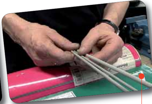
Praxistipp 1: Elektrodenführung in Zwangslagen
