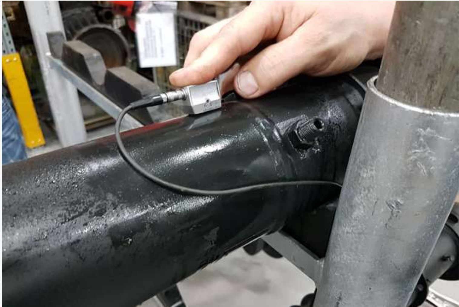
Ultraschallprüfung an der Serienachse
