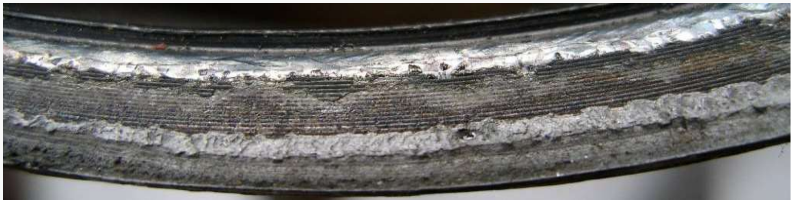
Bruchfläche auf der Rohrseite mit Drehriefen auf der Schweißnaht
