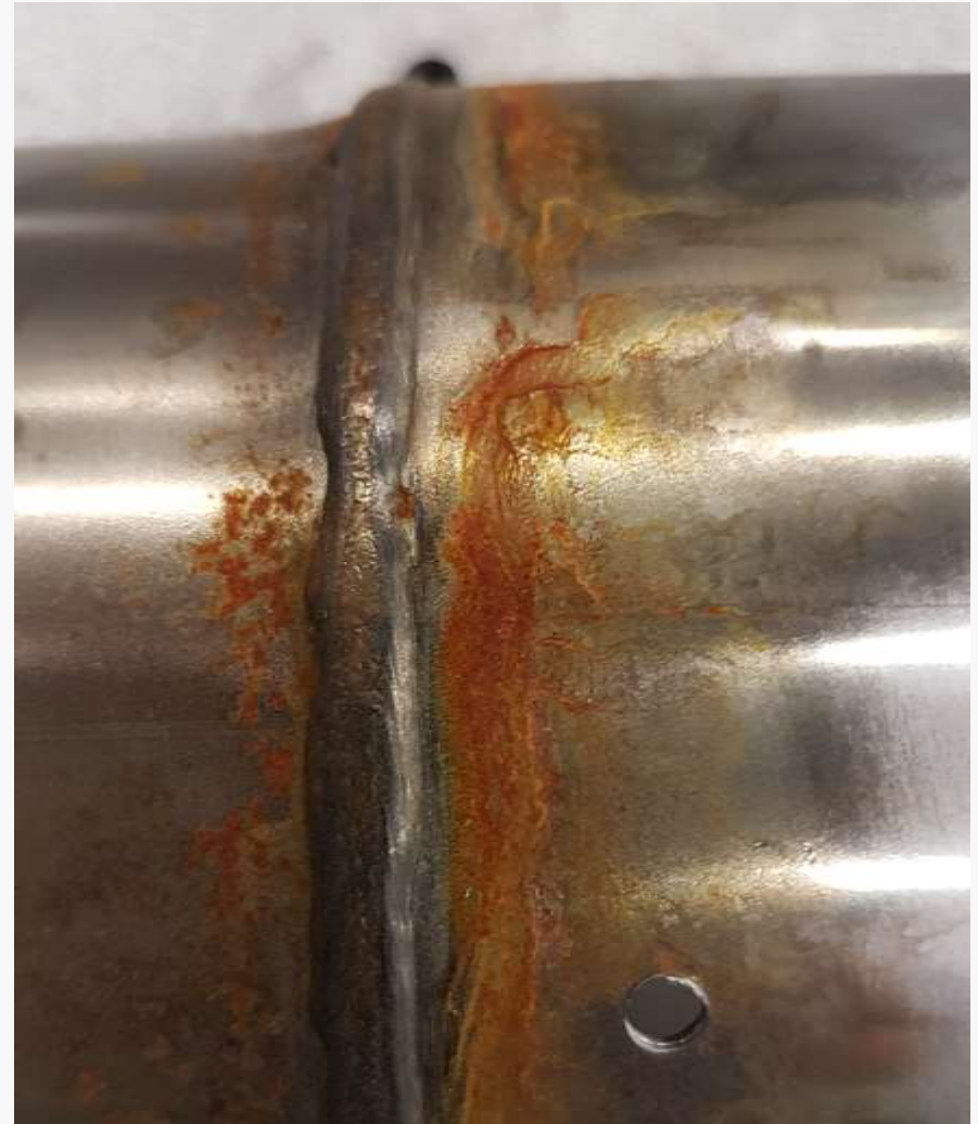
Auspuffendrohr aus 1.4301 – Anlassfarben mit Stahlbürste entfernt
