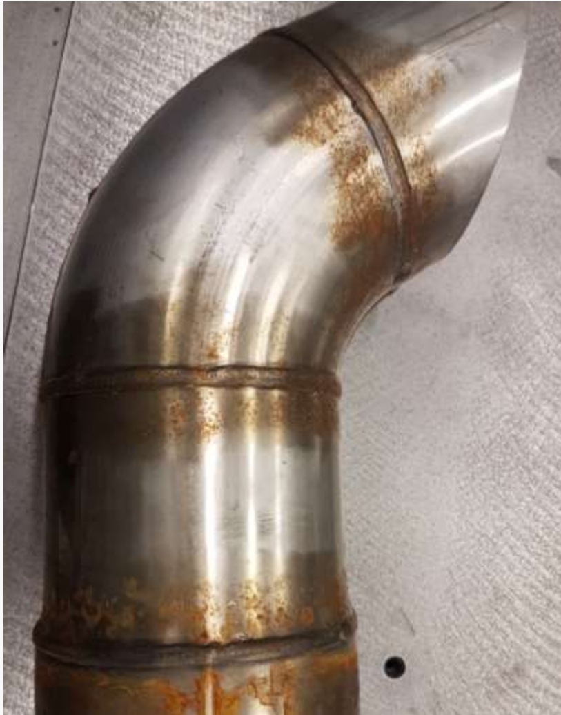
Auspuffendrohr aus 1.4301 – Anlassfarben mit Stahlbürste entfernt
