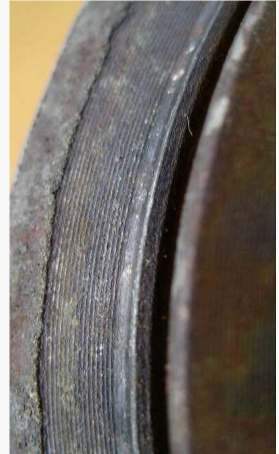
Bruchfläche auf der Zylinderaugenseite
