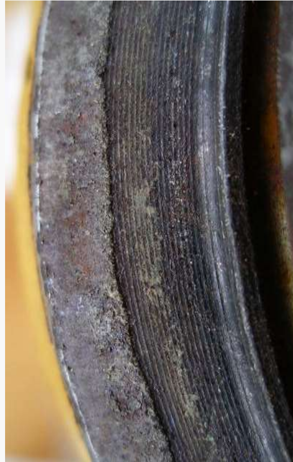
Bruchfläche auf der Zylinderaugenseite
