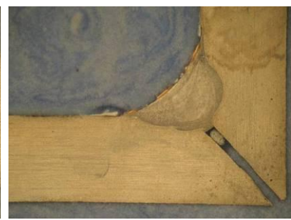
Bild 13: nicht durchgeschweißte Nähte
