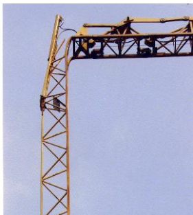
Bild 4 und 5: abgknickter Ausleger mit abgerissemem Zylinderauge
