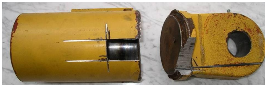
Bild 4 und 5: abgknickter Ausleger mit abgerissemem Zylinderauge
