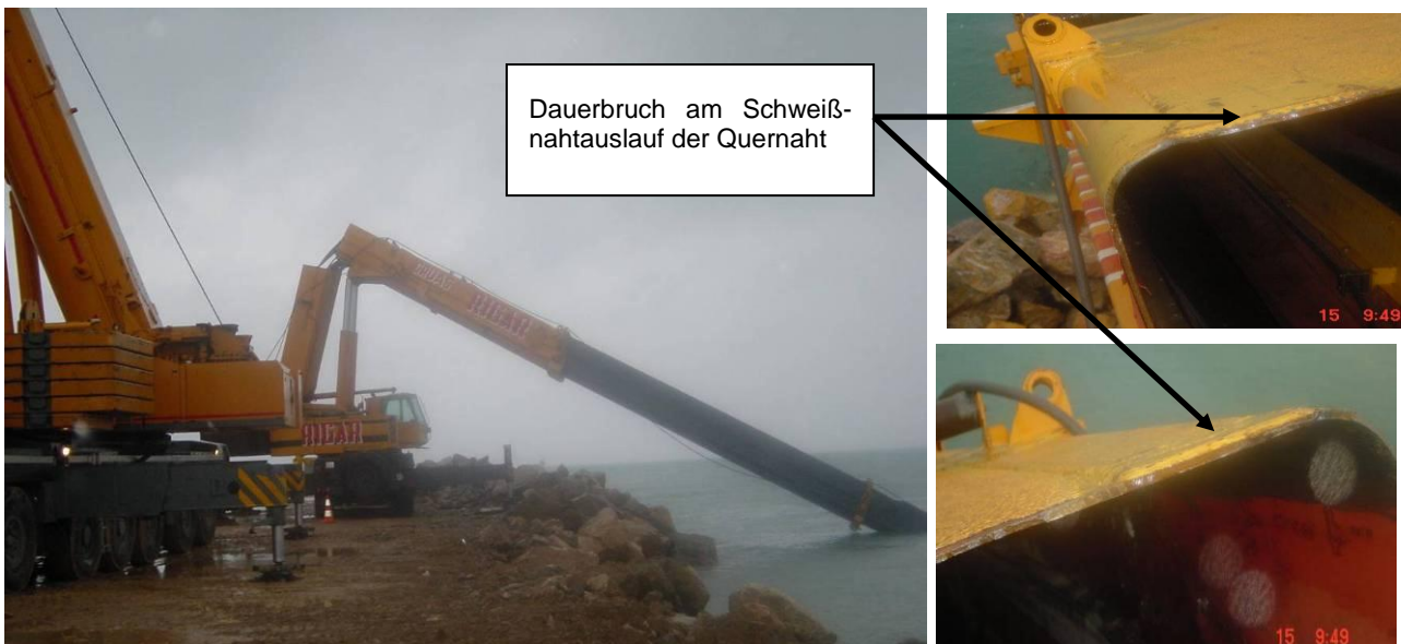
Bild 22: abgebr. Ausleger mit Dauerbrüchen an den Enden der Verstärkungsbleche
