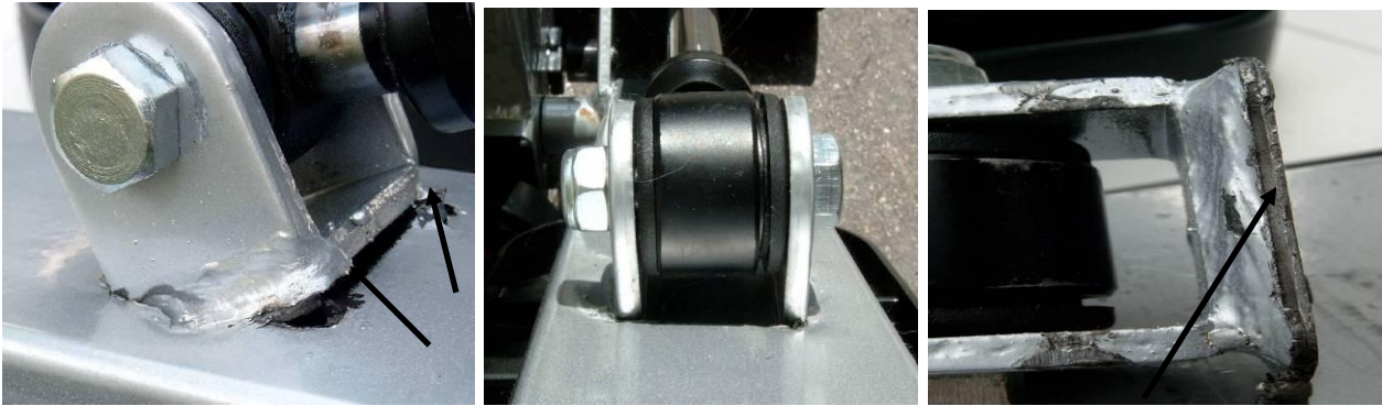
Bild 29: Zugzone keine Naht Bild 30: mittige Anordnung Bild 31: Dauerbruch
