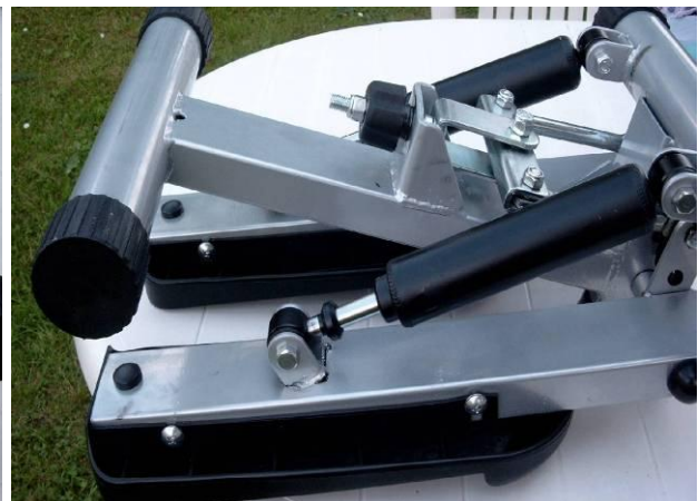
Bild 28: fast ausgerissener Haltewinkel
