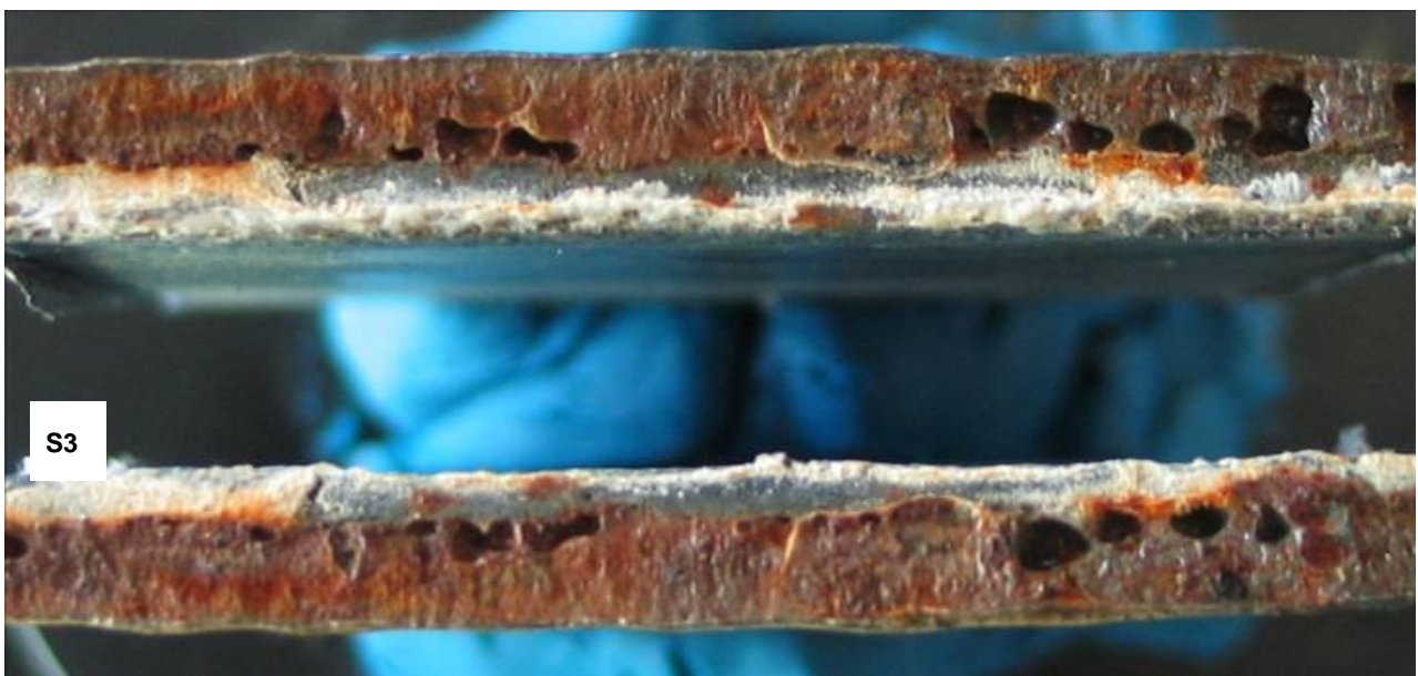
Bild 11: Längsschweißnaht im Bereich S 3 auseinandergefallen
