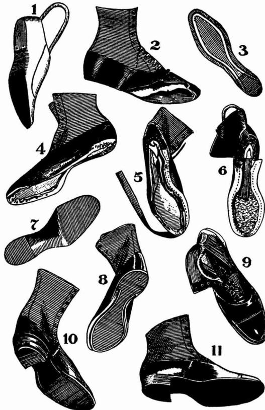
Fig. 5. Herstellen eines „randgenähten“ Schuhes. 1 Leisten, 2 Schäfft, 3 Brandsohle, 4 Schuh gewickelt und fertig zum Annähen des Rahmens, 5 Schuh mit teilweise angenähtem Rahmen, 6 Schuh mit ganz angenähtem Rahmen und fertig zum Auflegen der Sohle, 7 Außensohle, 8 Schuh mit Außensohle aufgelegt, beschnitten und geöffnetem Riß, fertig zum Doppeln, 9 Schuh mit angedoppelter Sohle, 10 Schuh mit aufgenageltem Absatz, 11 Schuh mit gefrästem Absatz und fertig zum Ausputzen.
