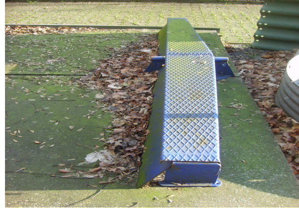
Abb. 3: Klappschieber mit Seilzug und Führungsschiene (links: STEINER und KECK, 2000 / rechts: Löpke/Pelzer)
