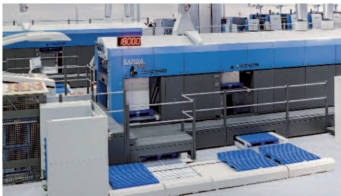
Die über 30 m lange Rapida 145 mit Doppelstapel-Auslage und automatisierter Logistik dürfte die grösste Bogenoffsetanlage der drupa 2016 sein.
