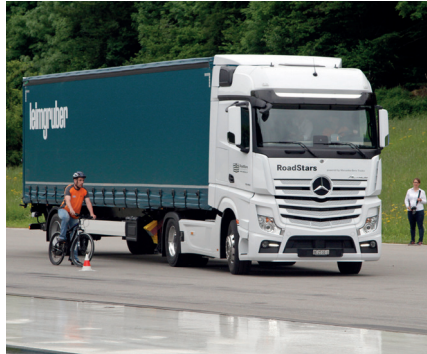
Ab 2022 in der EU Pflicht: Dank Seitenradar wird der Fahrer beim Abbiegen gewarnt.
