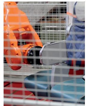
Neuster Mitarbeiter im Dauereinsatz: Ein Sechachsroboter wird seit Neustem für die Prüfung von Flugzeugsitzen eingesetzt.
