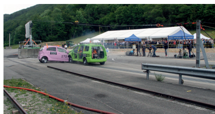
Zum 25-Jahr-Jubiläum zeigt das Team der passiven Sicherheit rund um Raphael Murri einen Crashtest, der weit in die Zukunft blickt: Ein Lufttaxi hat ein technisches Problem und muss notlanden. Seine Anfluggeschwindigkeit betrug 30 km/h. Die Umfildsensorik des autonom fahrenden Fahrzeuges erfasste das Luftobjekt zu spät und prallt mit 50 km/h in das Lufttaxi. Von 2D- zu 3D-Crash!
