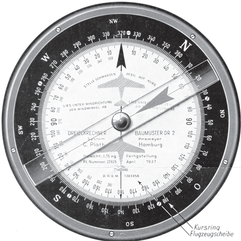
Bild 1: Rückseite des Dreieckrechners mit den Begriffen, die diese Rechenscheibe (mehr oder weniger angepasst) jahrelang kennzeichnen sollten: Dreieckrechner Baumuster DR 2 – System Knemeyer – Fl. Nummer: 23825 – Fertigstellung – D. R. G. M. (Quelle: Plath 1938, S. 2)
