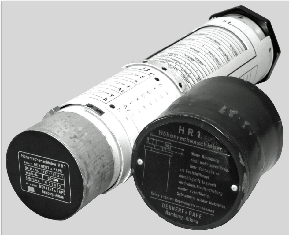
Bild 48: Modell- und Typenbezeichnung »Höhenrechenschieber HR 1« mit der Herstellerbenennung DENNERT & PAPE: links als erhabene Prägung und goldfarben eingefärbt auf dem Zylinderboden des Rechenschiebers (in Bild 49 vergrößert); rechts als aufgenietete Plakette auf dem (verbeulten) Behälterdeckel; Tubus und Deckel bestehen aus Nichteisenmetall, vermutlich eine Zinn- oder Zink-Legierung, weil verlötet (Quelle: Eigene Sammlung)
