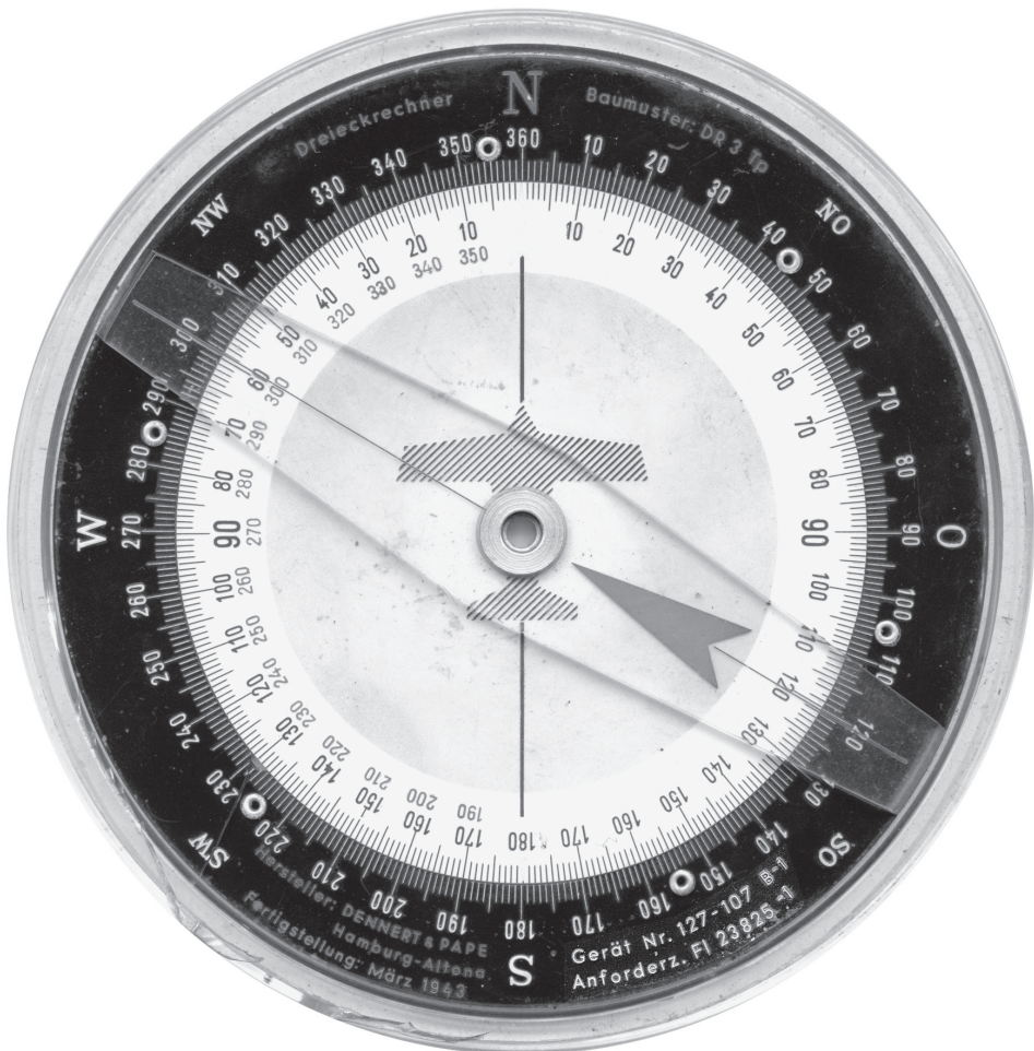
Bild 26: Exemplar »Baumuster: DR 3 Tp« mit Greifring aus Kunststoff (links unten angesplittert), Kursring durchgehend vernietet, Kennzeichnungen »Gerät Nr.« und »Anforderz.« der besseren Lesbarkeit halber im Bild etwas aufgehellt; die Abbildung dieses Modells mit denselben Bezeichnungen findet sich auch in der Original-Dokumentation: Dennert & Pape 1944, S. 9 (Quelle: Eigene Sammlung)
