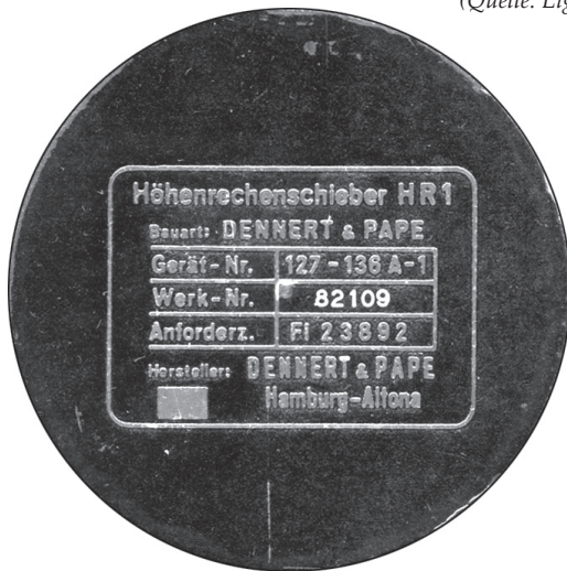
Bild 49: Geprägte Modell- und Typenbezeichnung auf dem Zylinderboden des Rechenschiebers; die Werk-Nr. 82109 ist in den Aluminium-Boden eingefräst (!) und deshalb silberfarben, hier in der Farbe weiß zu sehen (Quelle: Eigene Sammlung)
