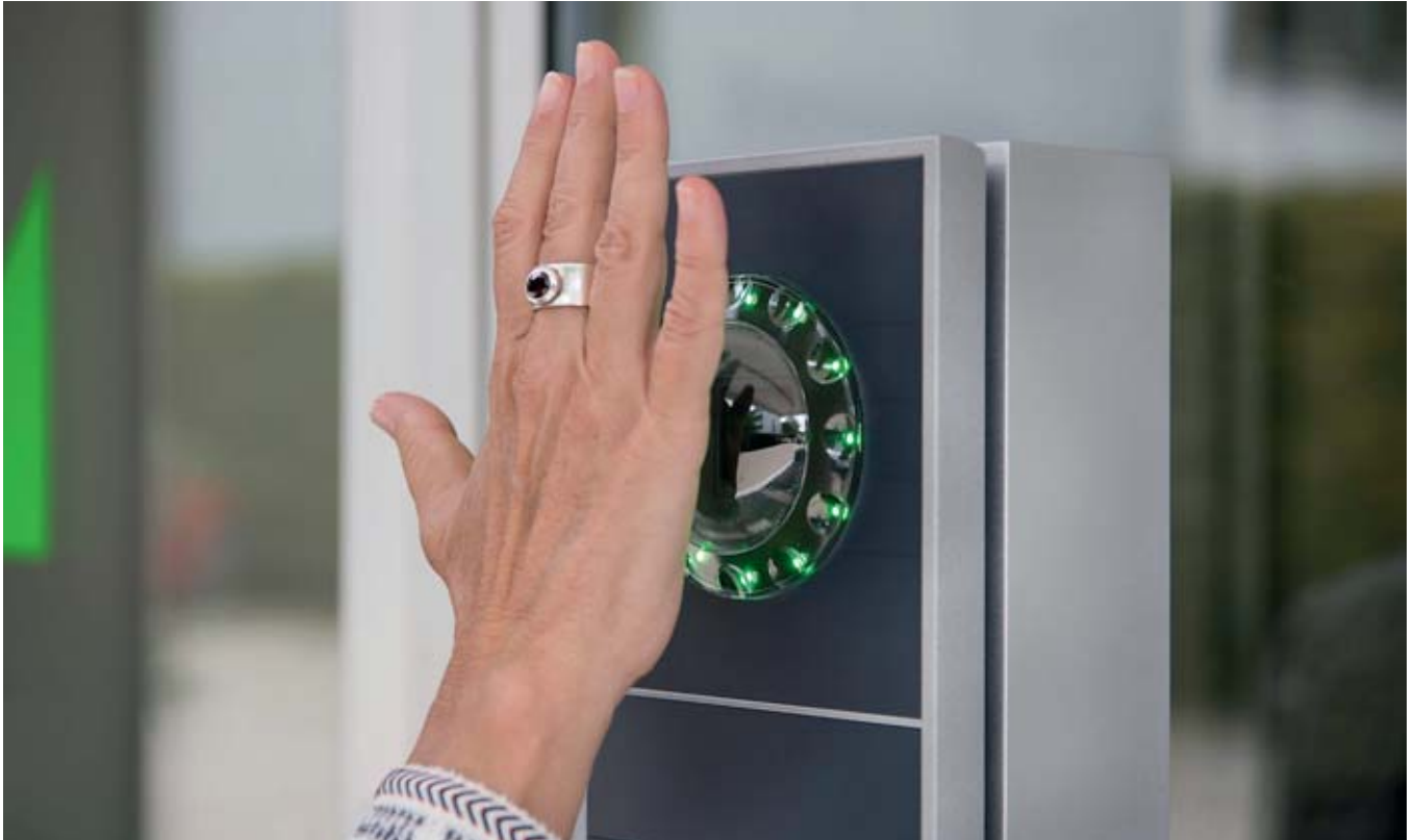
Bild 1: Die Handvenenerkennung identifiziert eine Person schnell, ergonomisch und hygienisch
