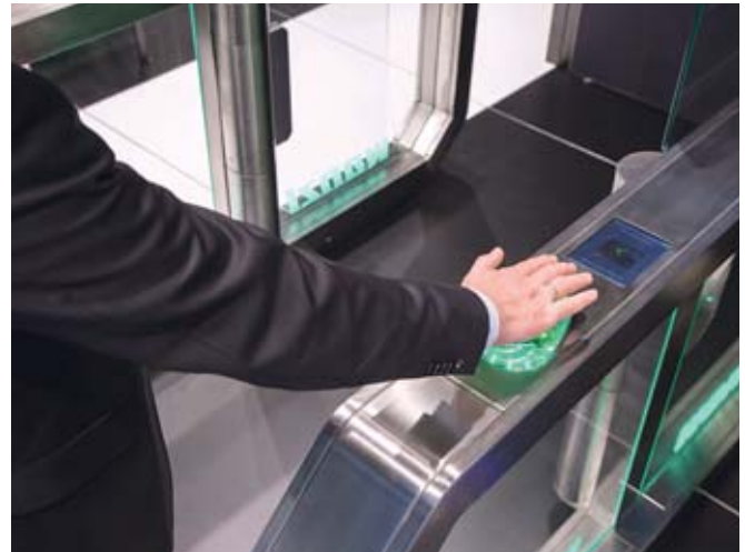
Bild 3: Der Handvenensensor kann als Einbaumodul auch in Vereinzelungsanlagen integriert werden, wie hier im »Galaxy Gate« von Wanzl
