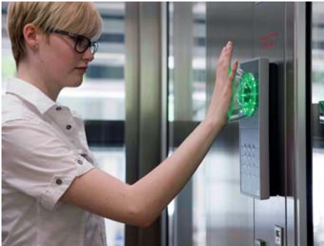
Bild 2: Für eine Zwei-Faktor-Authentifizierung im Aufzug lässt sich die Handvenenerkennung mit PIN oder RFID-Ausweis kombinieren
