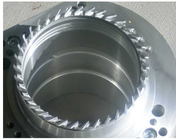
Bild 16: Drallring vor Einlass-Laufbüchse
