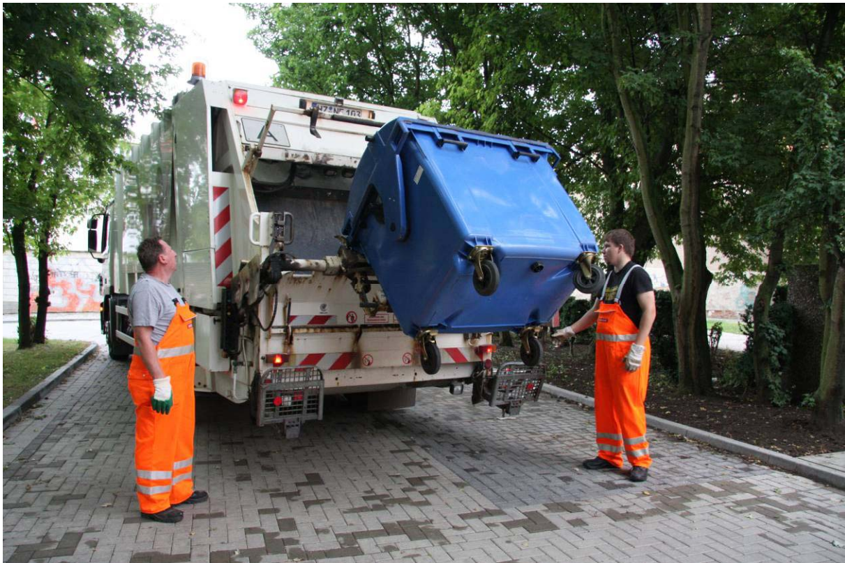
Bild 3: Entleerung von 4-Rad-Altpapierbehältern mit Heckladertechnik
